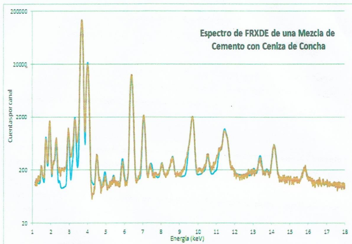
Figura 1. Espectro de FRXDE de una mezcla de cemento con ceniza de concha en escala semi logarítmica. Incluye el pico de Ar del aire y los picos de rayos-X de Au dispersados por la muestra. La curva en azul muestra el espectro simulado
