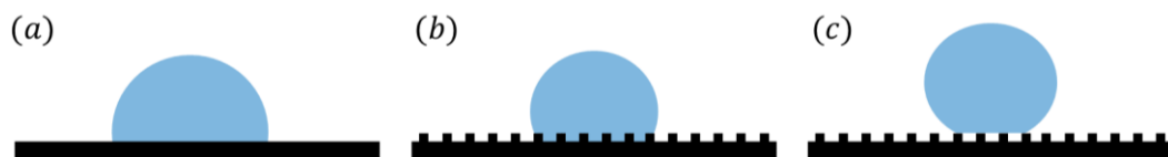
Abbildung 2.3: (a) Benetzungszustand auf einer glatten Oberfläche im Vergleich zu den Benetzungszuständen auf einer rauen Oberfläche nach (b) Wenzel und (c) Cassie und Baxter .
