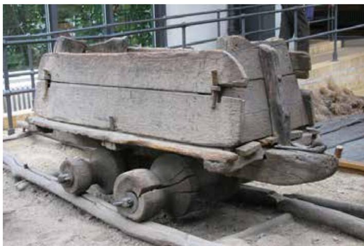
Рис. 8. Деревянная вагонетка на деревянных направляющих (лежнях) с колёсами, имеющими реборды.
