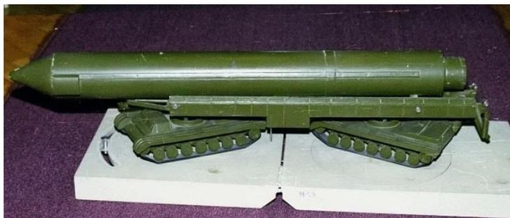
Рис. 2. Самоходная пусковая установка «объект 825» (макет) (Музей истории и техники ОАО «Кировский завод», 2001 г. Фото: bastion-karpenko.narod.ru<sup>4</sup>).
