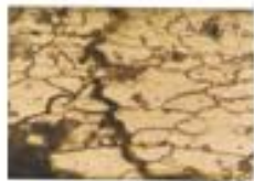
Gb 4b Struktur mikro penampang B-B (320x) Korosi batas butir
