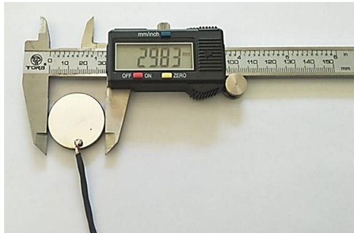
Gambar 1. Elemen aktif piezoelektrik
