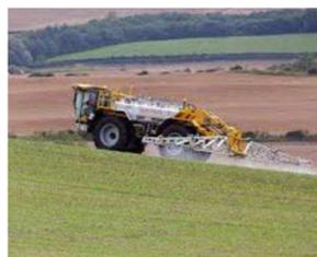
Gambar 4. Alat penyemprot (*Sprayer*) menggunakan traktor
