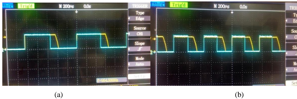
Gambar 13. (a) Sinyal pensaklaran pada frekuensi 1kHz dan (b) frekuensi 1,8 kHz
