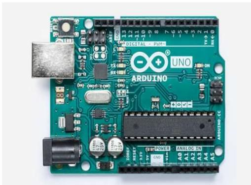
Gambar 6. Mikrokontroler arduino uno
