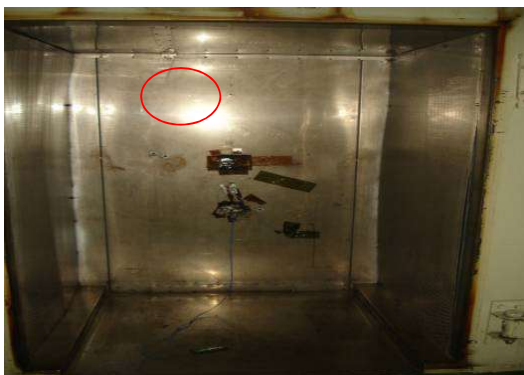
Gambar 9. Posisi sensor thermocouple di dalam mesin oven
