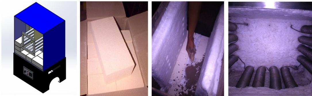
Gbr.3.9 & 3.10 Pemasangan Batu Tahan Api dan Proses Pemasangan Bata Gambar 3.11 Element Pemanas
