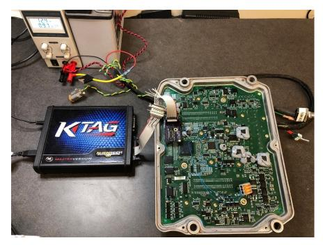
Figure 41. KTAG Reflash Setup
