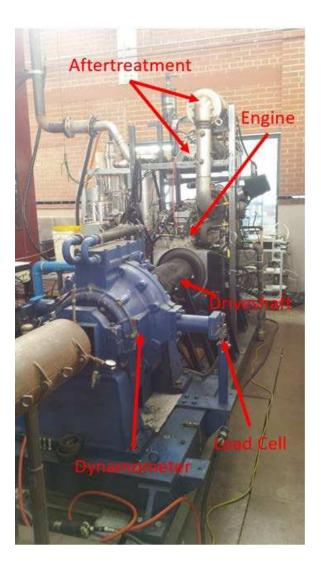
Figure 12. Engine & Dynamometer Test Stand
