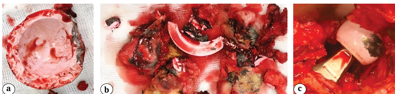
Рис. 5. Внешний вид фрагментов керамического вкладыша: а — крупный фрагмент керамического вкладыша (центральный) размером 20×20 мм со следами контакта с металлом (черный цвет); б — средние (15×6 мм) и мелкие (2×3 мм) фрагменты с иссеченными окружающими тканями; в — головка бедренного компонента со следами контакта с металлом (черный цвет)
