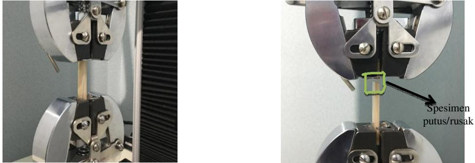
Gambar 6. Pengujian spesimen komposit sampai rusak atau putus.
