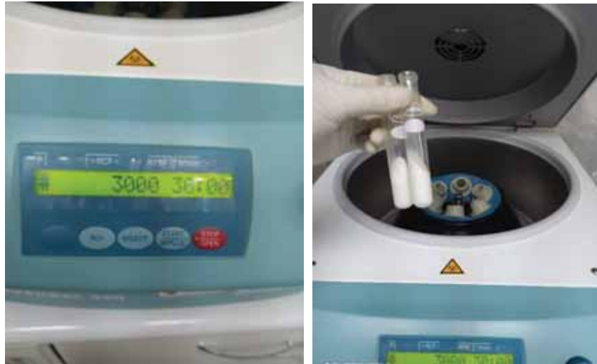
Foto N° 24 y 25: Centrifugación de la emulsión a 3000 rpm por 30 minutos Fuente: Fotografías propias
