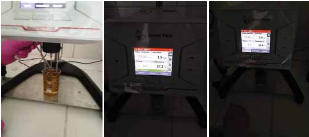
Foto N° 1, 2 y 3: Medición de la viscosidad del aceite de kañiwa Fuente: Fotografías propias
