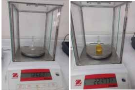
Foto N° 7 y 8: Foto obtención de la masa del picnómetro y del aceite Fuente: Fotografías propias
