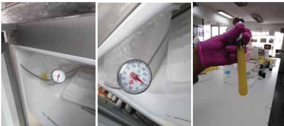
Foto N° 14, 15 y 16: Determinación del punto de fluidez y punto de nube del aceite de kañiwa
