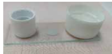
Foto N° 32, 33 y 34: Medición de la extensibilidad de la emulsión con diferentes pesos (peso del porta objeto, 2 g y 5 g)
