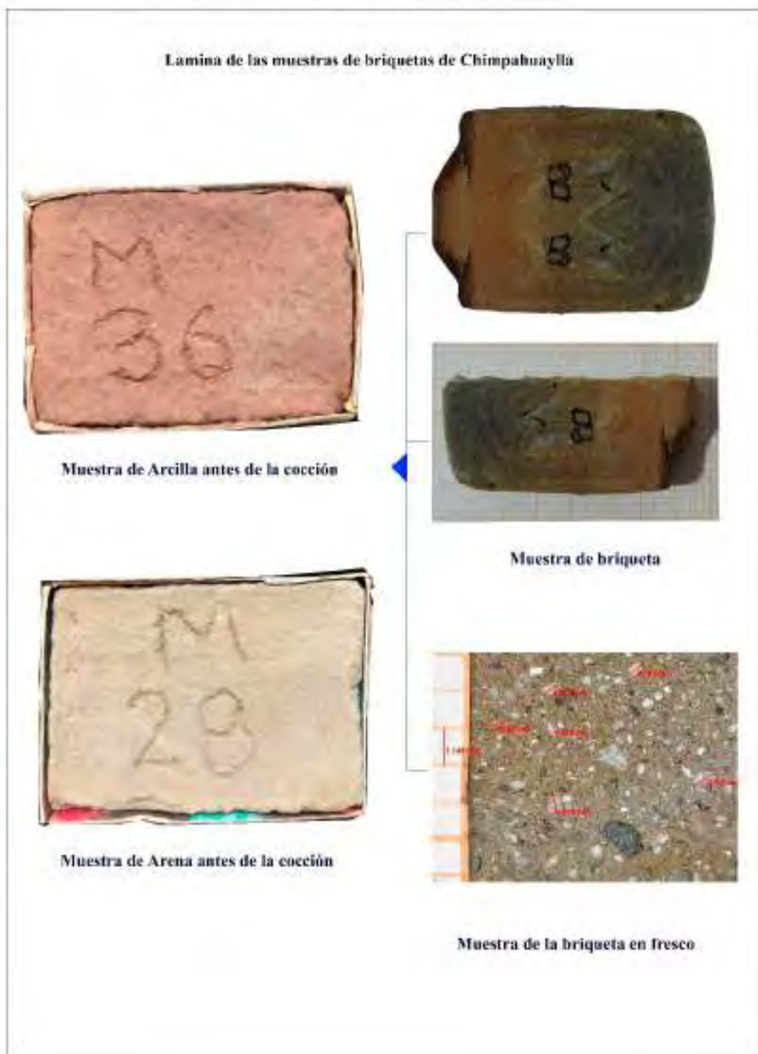
Figura 11.- Se observa las briquetas, con las muestras de arcilla y arena obtenidas de la prospección geológica en Chimpahuaylla-San Jerónimo-Cusco.
