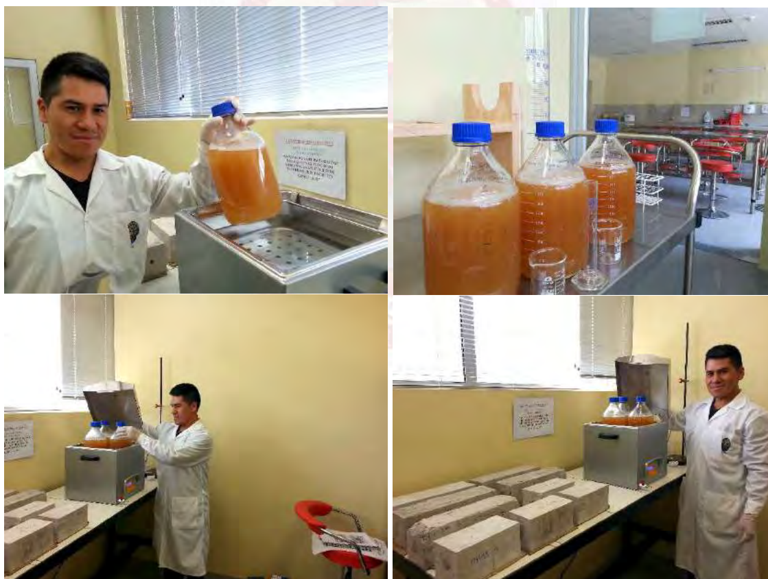
Figura 16. Colocación de cultivo bacteriano ( Bacillus. subtilis ) en baño isotérmico.
