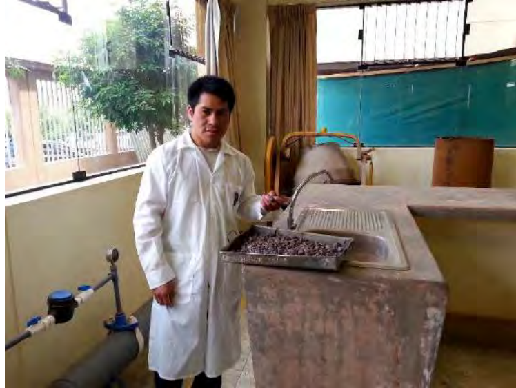
Figura 26. Muestra de agregado grueso para el tamizado.
