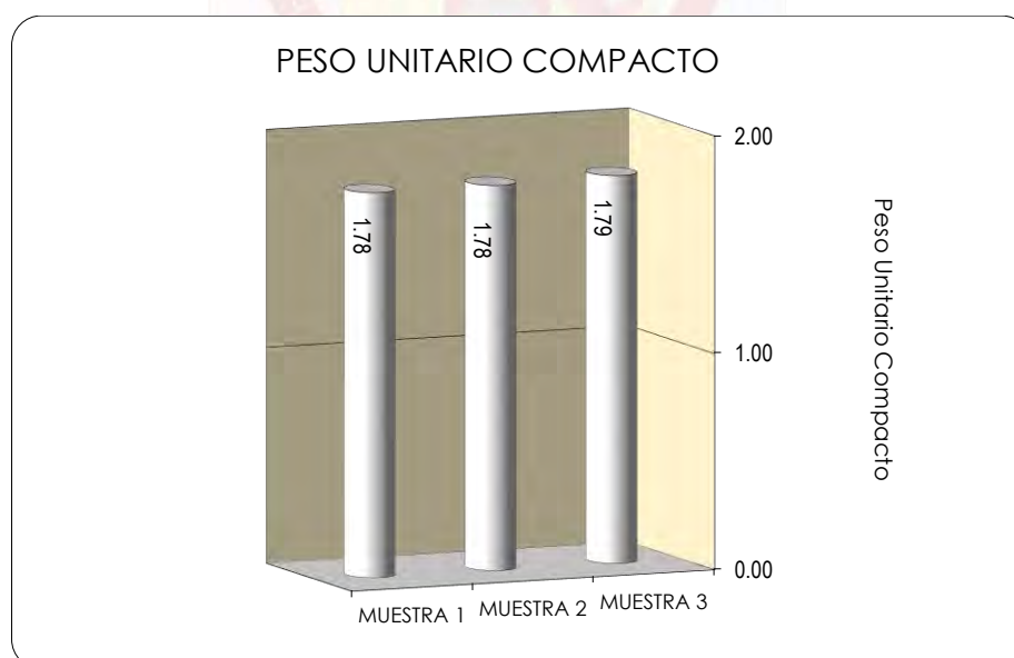
Figura 82. Peso unitario compactado de agregado fino.
