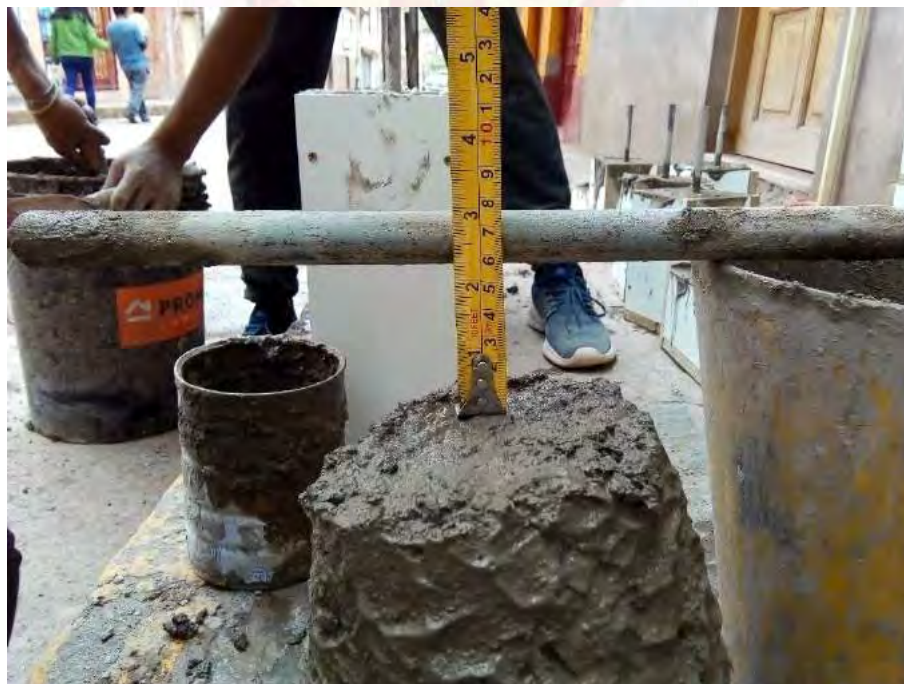
Figura 33. Medición del Slump del concreto.
