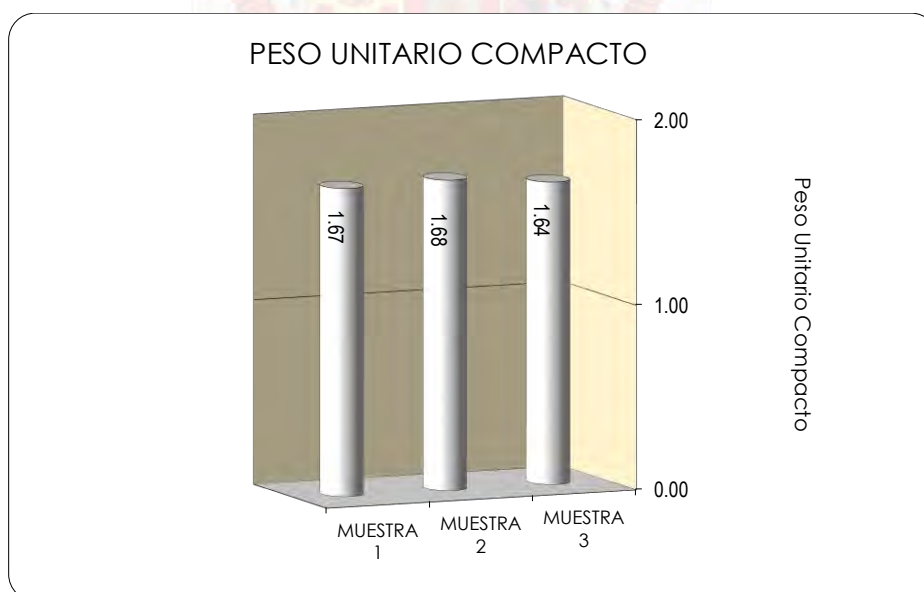
Figura 84. Peso unitario compactado de agregado grueso.
