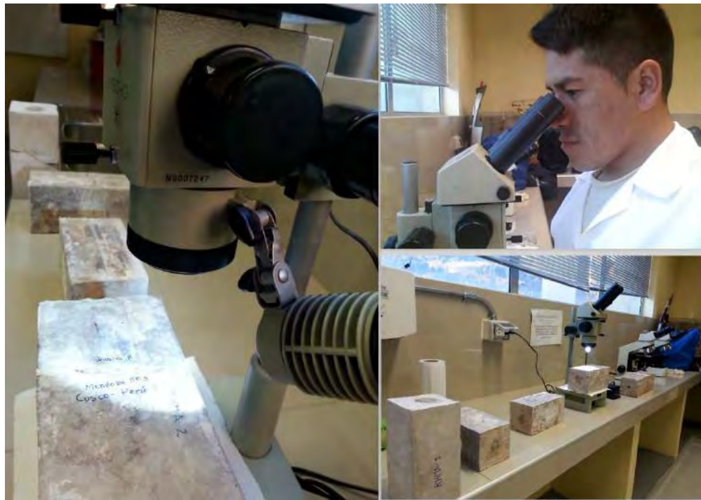
Figura 99. Observación a nivel estereoscopio de la precipitación de \text{CaCO}_3 .
