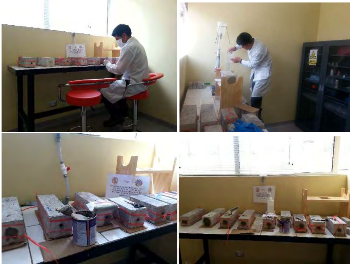
Figura 65. Sellado de agujero de prisma.
