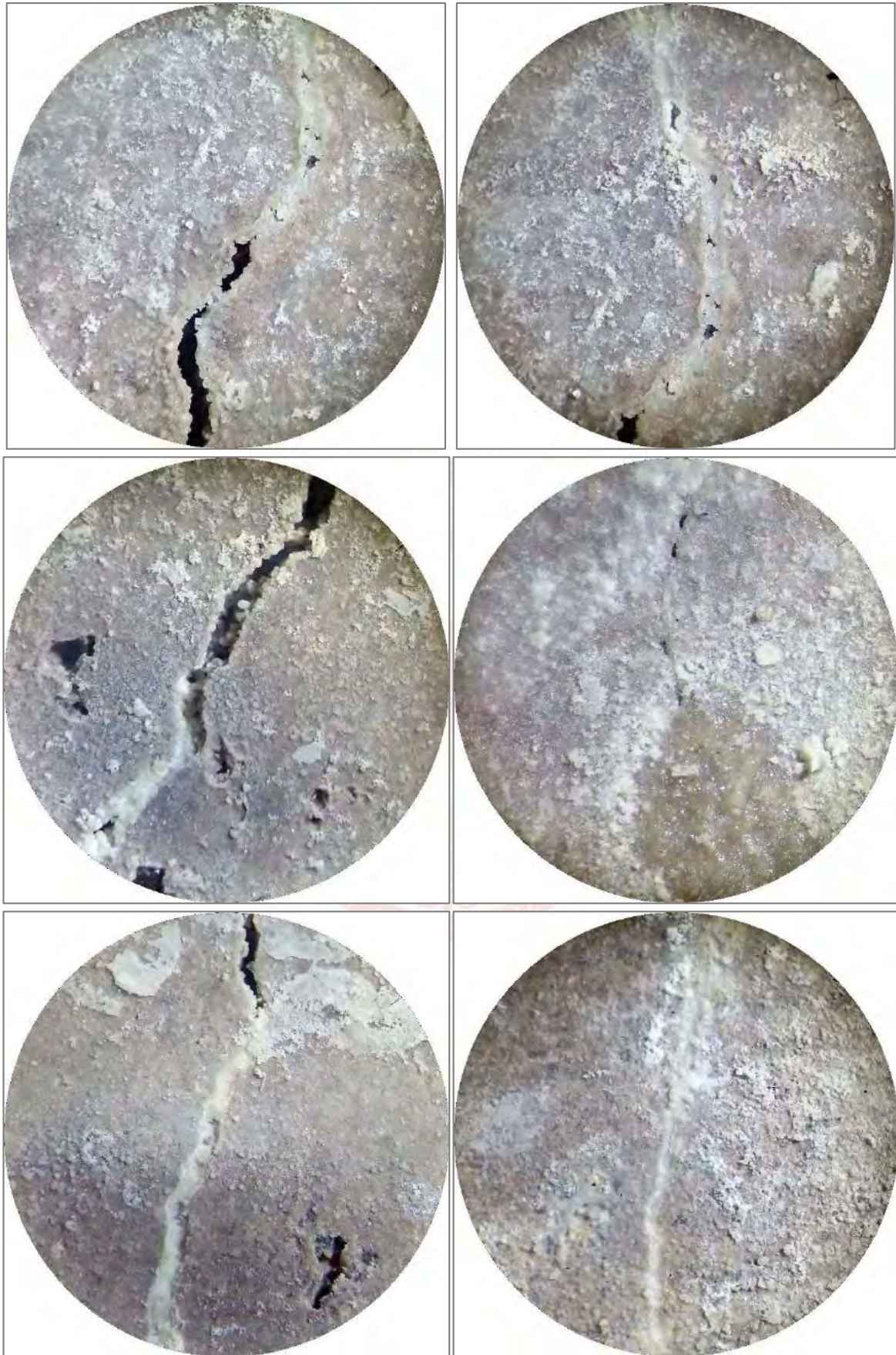
Figura 112. Observación estereoscópica de la precipitación de \text{CaCO}_3 a base de bacterias a los 58 días.
