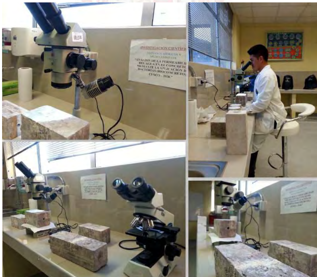
Figura 100. Observación mediante estereoscopio con objetivo a 2x y 4x; y ocular a 8x (con aumento de 16X y 32X).
