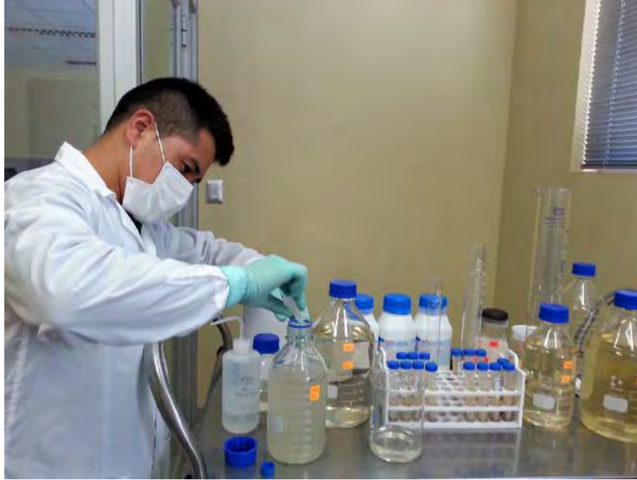
Figura 59. Adición de esporas bacterianas en solución A y B.
