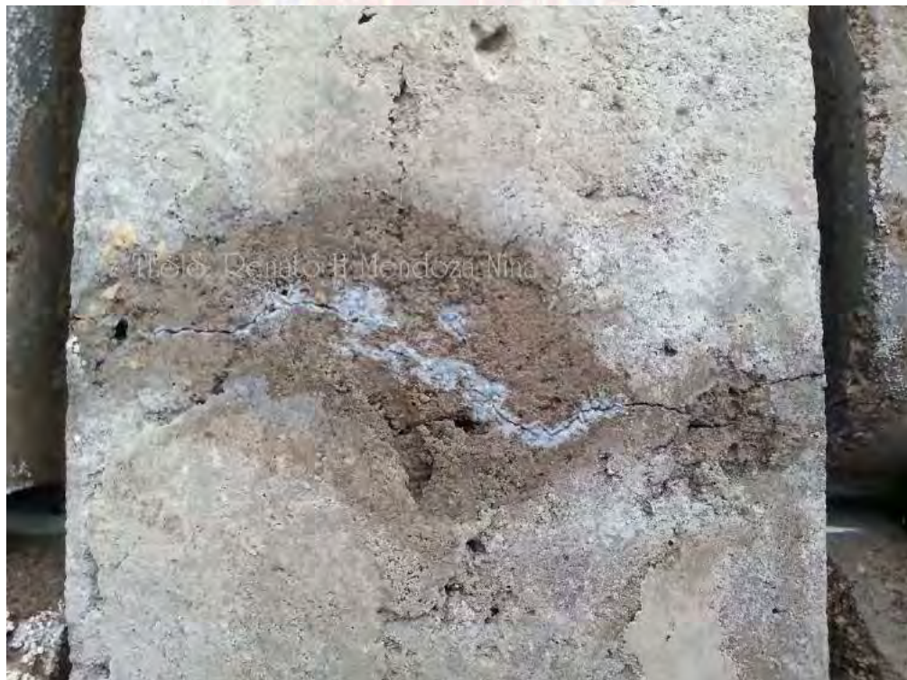
Figura 90. Bio-precipitación de \text{CaCO}_3 a base de bacterias a los 12 días.
