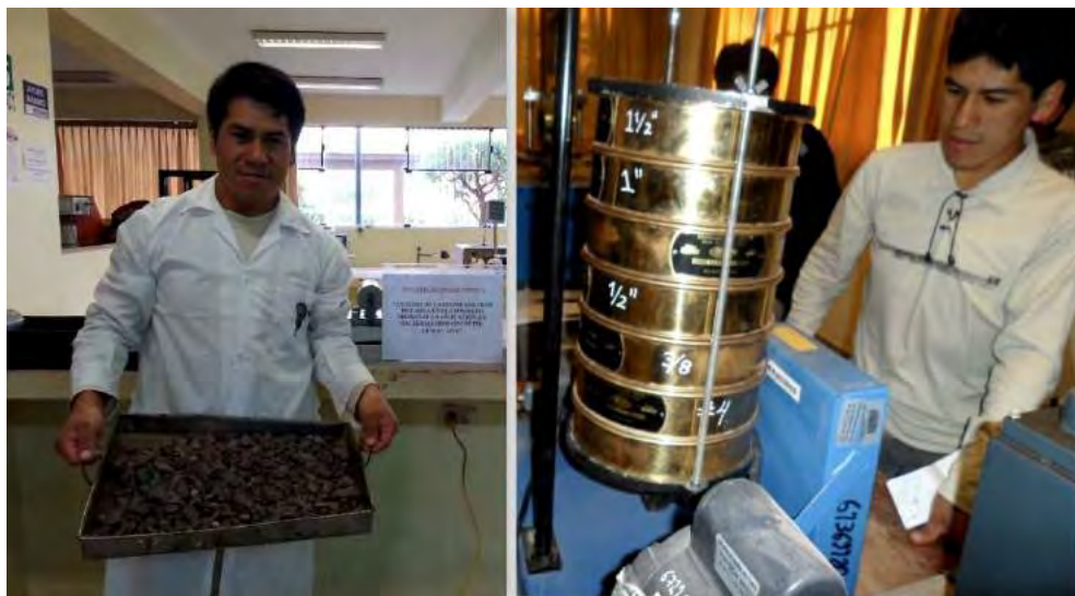
Figura 28. Tamizado del agregado grueso.
