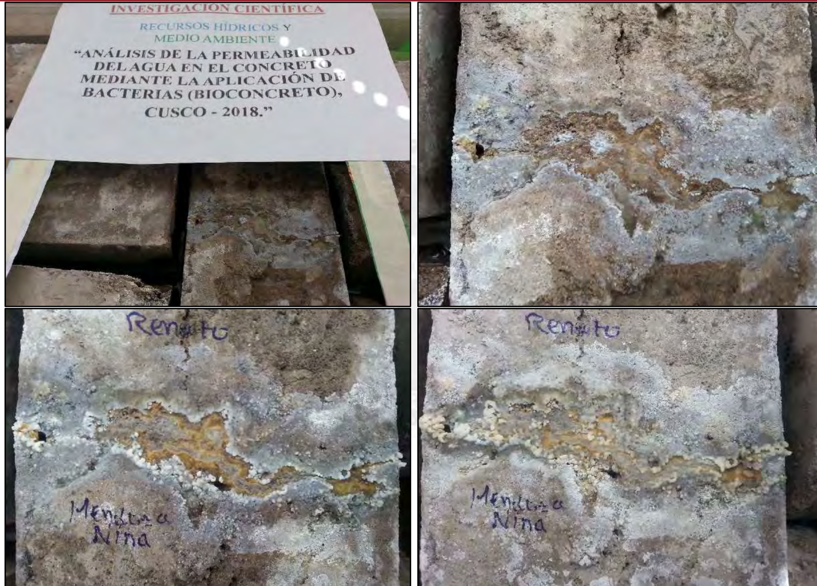
Figura 96. Proceso de bioprecipitación de \text{CaCO}_3 , mediante la aplicación de Bacillus subtilis .
