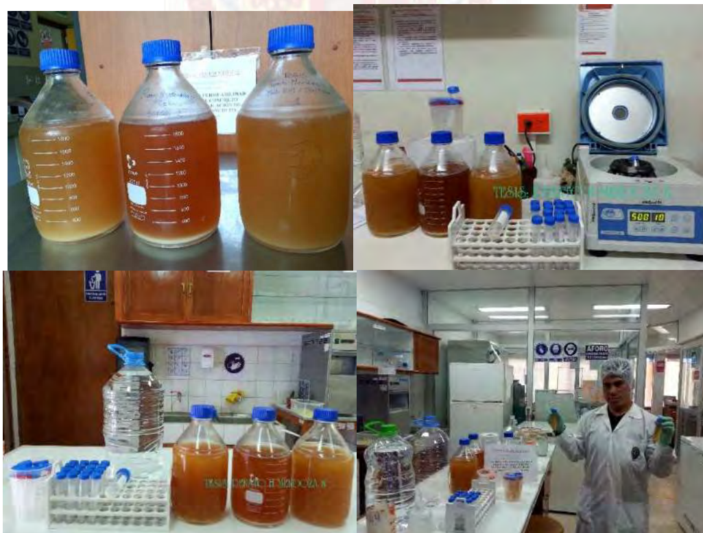
Figura 18. Proceso de decantación para la centrifugación del cultivo bacteriano.
