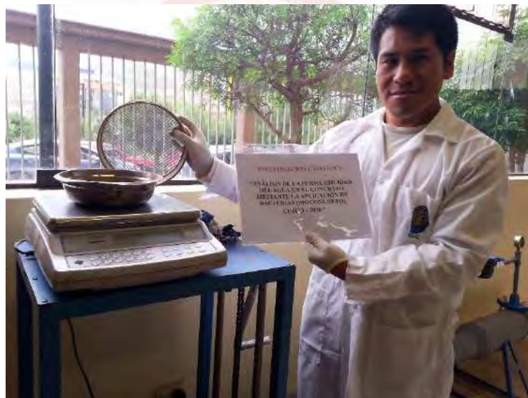
Figura 24. Pesaje de agregado fino retenido en cada tamiz.
