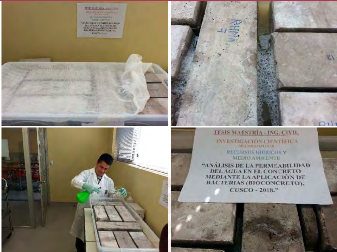
Figura 89. Proceso de auto-curación del concreto a base de bacterias.
