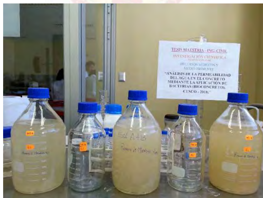
Figura 62. Mezcla de solución bio-precipitadora.
