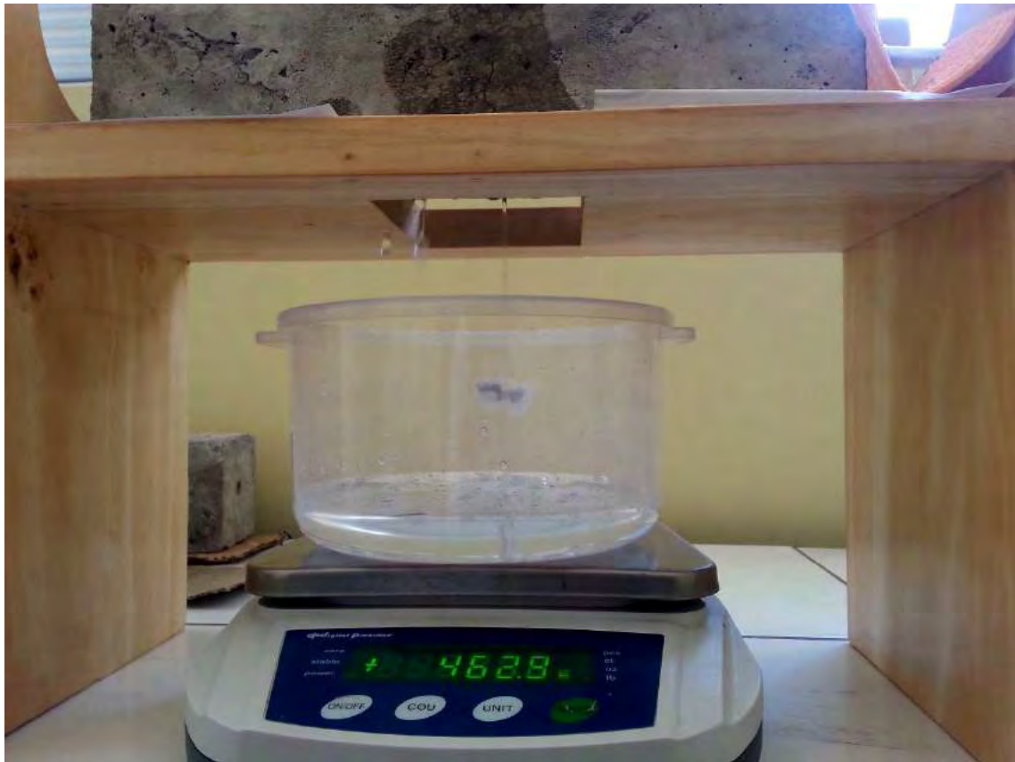
Figura 67. Prueba de permeabilidad antes de la bioprecipitación.
