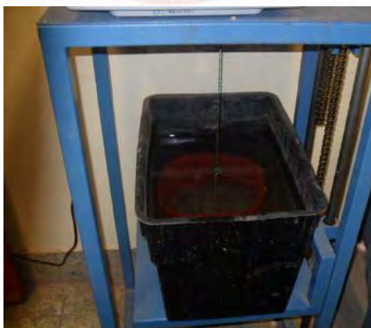
Figura 30. Muestra sumergida de agregado grueso.
