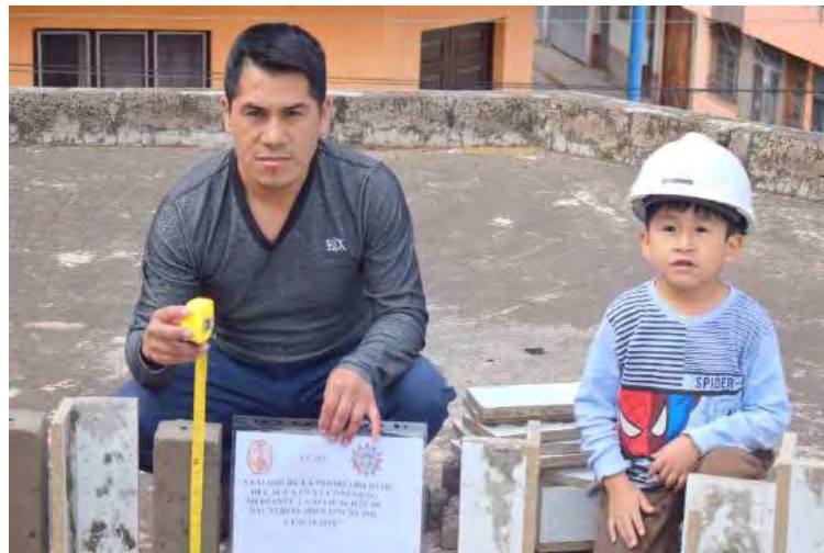
Figura 38. Medida de altura del prisma de concreto.
