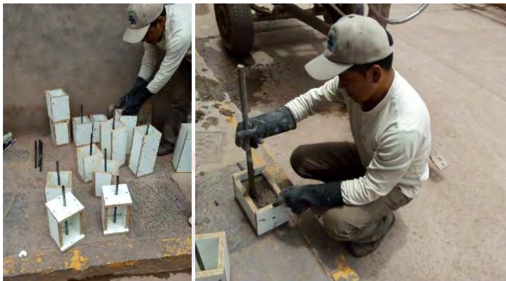
Figura 36. Colocación de acero liso \varnothing \frac{1}{2} " y elaboración de prismas de concreto.
