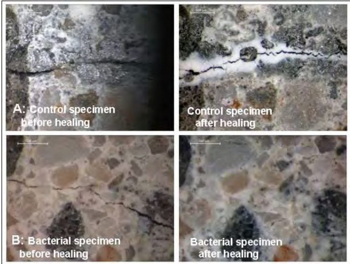
Figura 124. Imágenes estereoscópicas microscópicas (40 veces de aumento) de la muestra pre-fisurada (A) y con bacteria (B) antes (izquierda) y después (derecha) de la curación por inmersión en agua durante un período de dos semanas. La precipitación mineral se produjo predominantemente cerca del borde de la fisura en el control, pero dentro de la fisura en muestras bacterianas (Jonkers, 2012).
