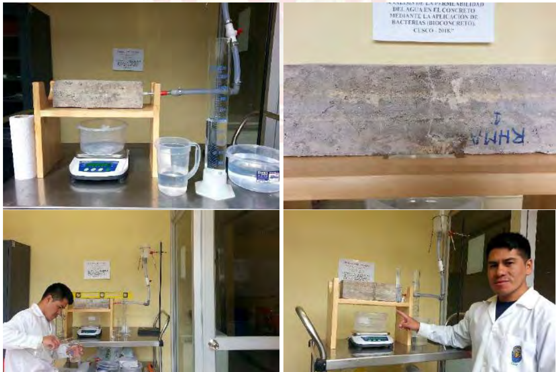
Figura 70. Prueba de permeabilidad después de la bio-precipitación.
