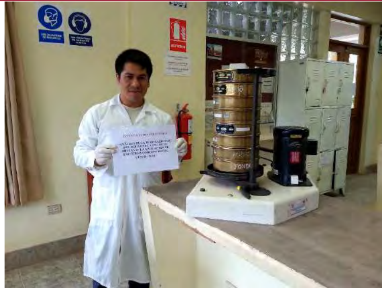
Figura 23. Tamizado del agregado fino (3/8", #4, #8, #16, #30, #50, #100, #200, fondo).
