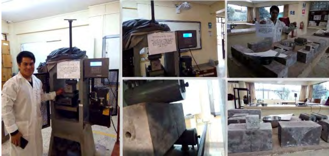
Figura 45. Ensayo a flexión y creación de fisuras de manera controlada.
