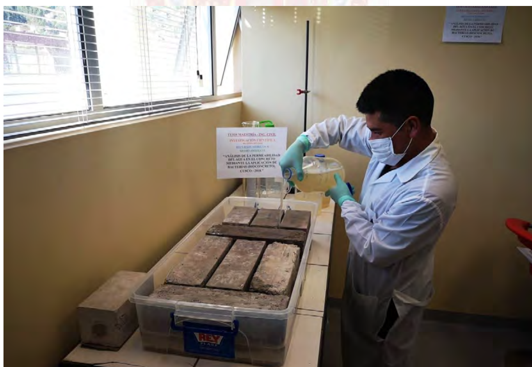
Figura 64. Prismas inmersos en solución bio-precipitadora de \text{CaCO}_3 .
