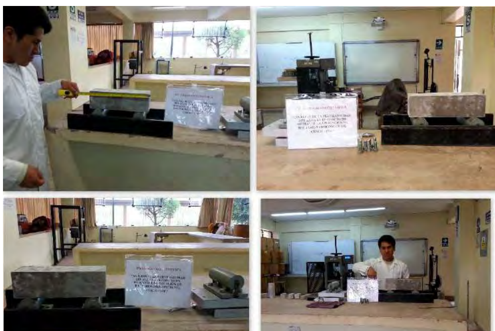
Figura 42. Proceso de medición de los prismas de concreto y dimensionamiento de los apoyos para el ensayo a flexión.
