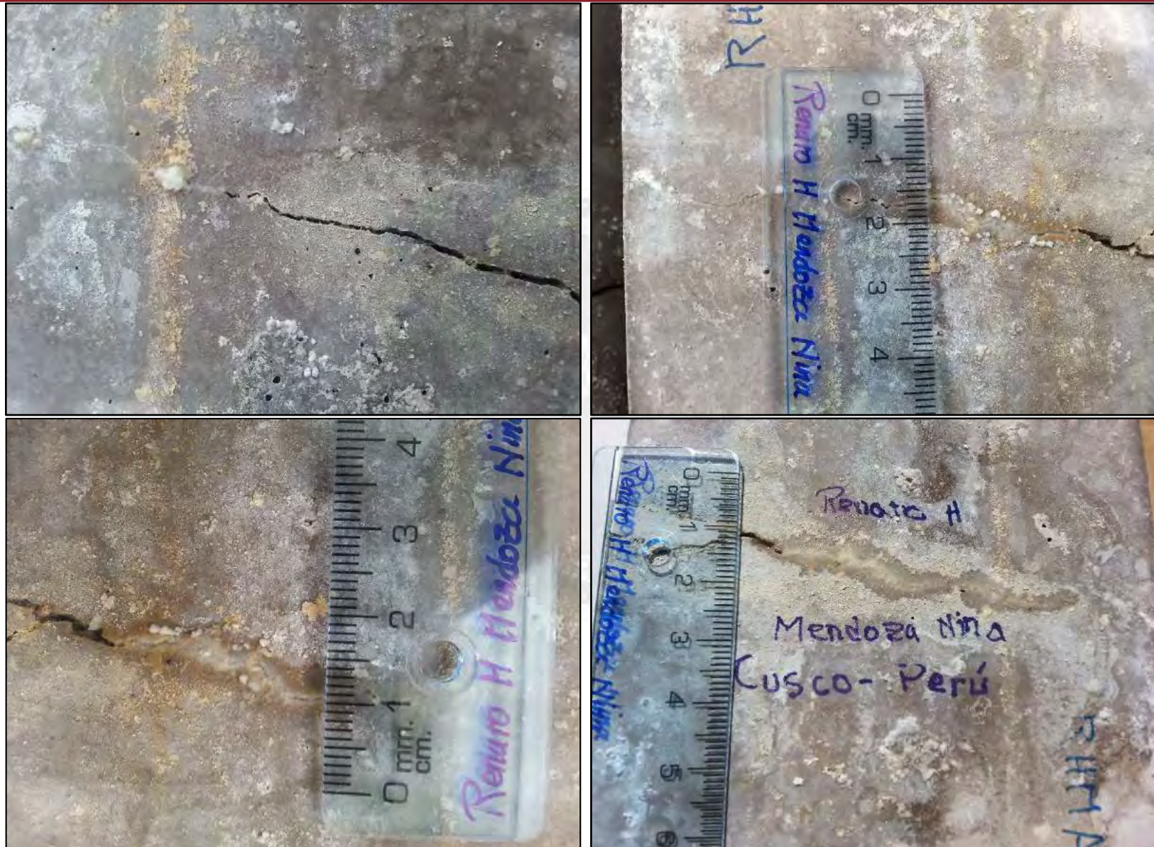
Figura 95. Bioreparación de fisuras de las muestras de concreto mediante las bacterias (86 días).
