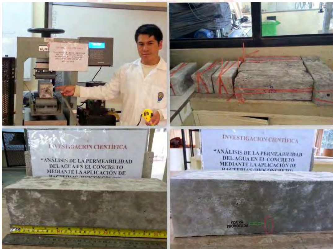
Figura 46. Creación de fisuras de manera controlada.
