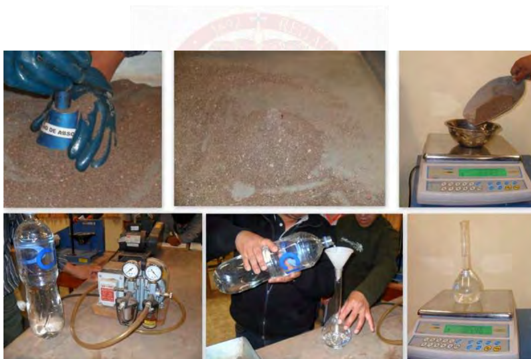
Figura 29. Ensayo de peso específico del agregado fino.
