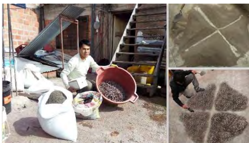
Figura 21. Muestreo de agregado fino y grueso.
