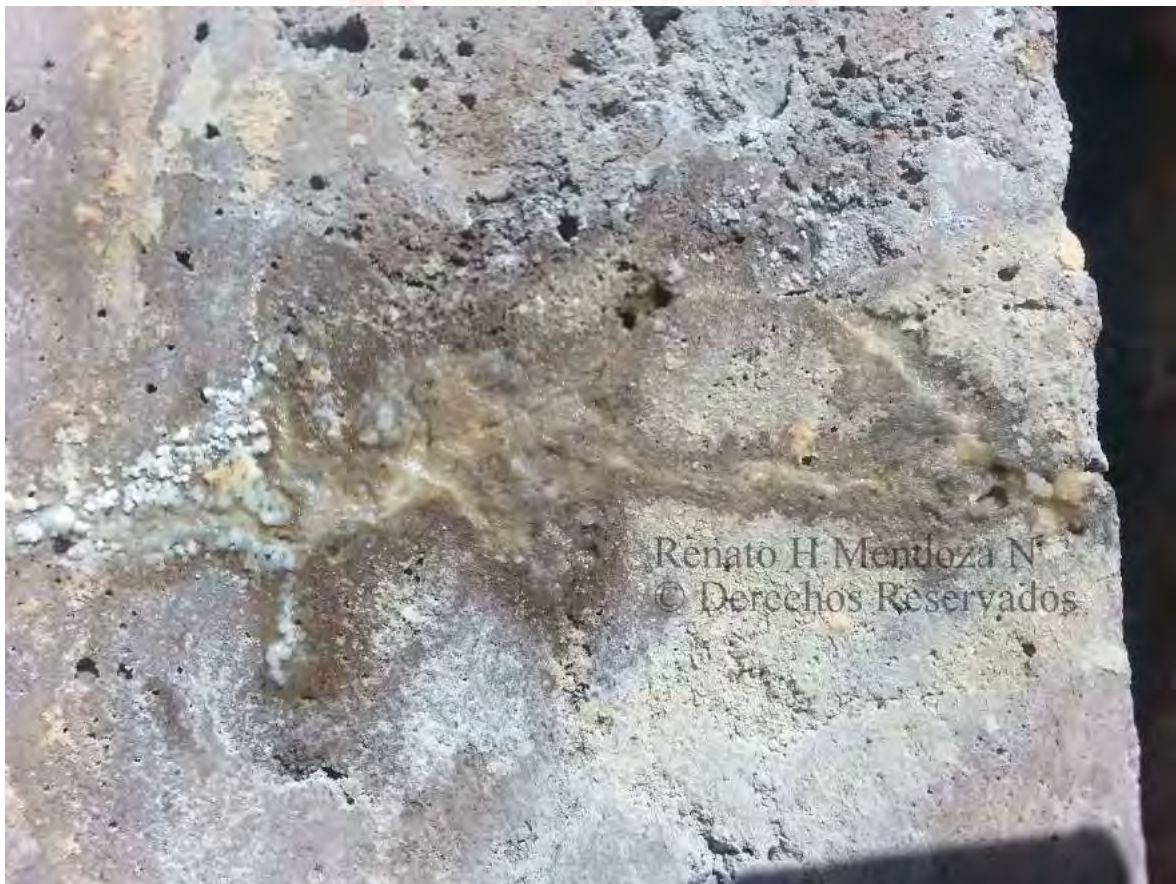
Figura 110. Autosación del concreto a base de bacterias a los 86 días (self healing concrete by use of bacteria).
