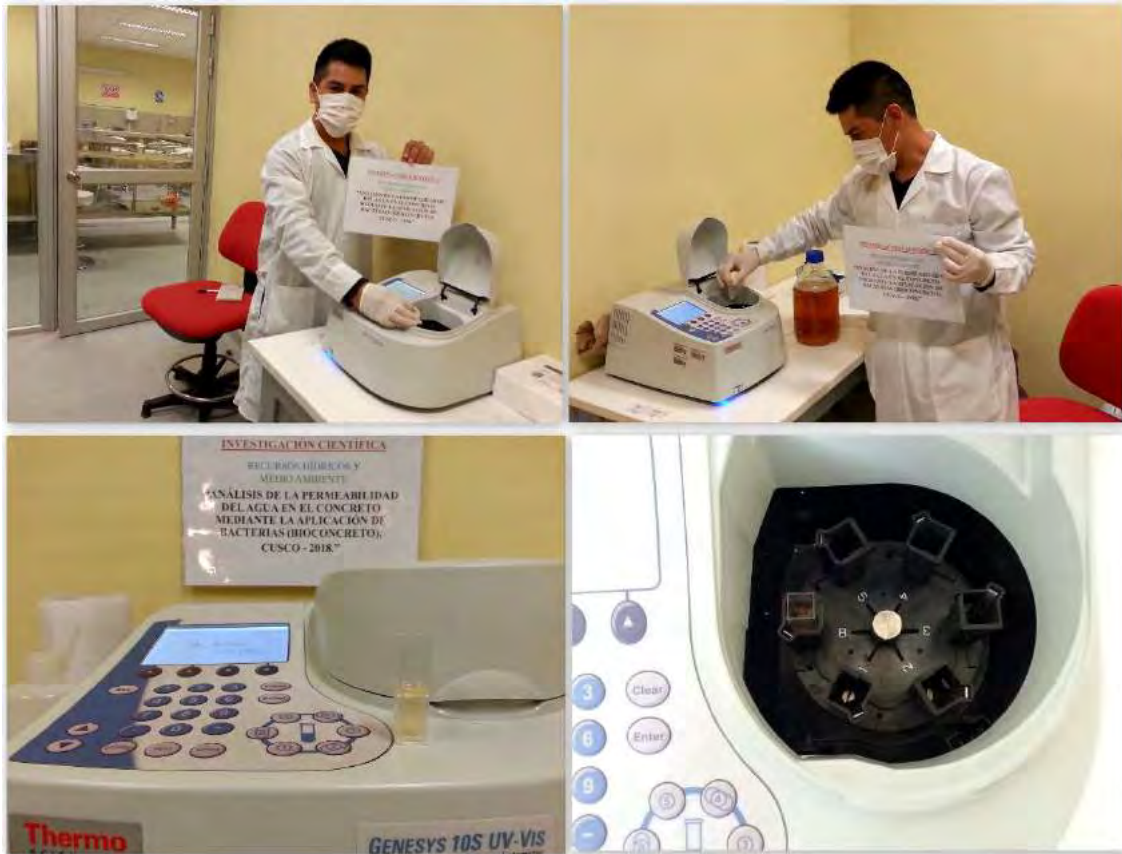
Figura 11. Se depositó en pequeñas cubetas (12.5 x 12.5 x 45 mm), esta cubeta se colocó dentro del espectrofotómetro.
