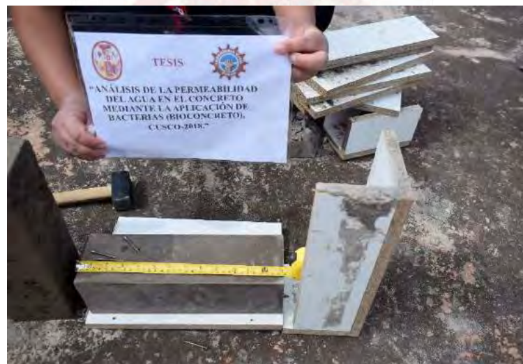
Figura 39. Medida horizontal del prisma de concreto (L=34 cm).
