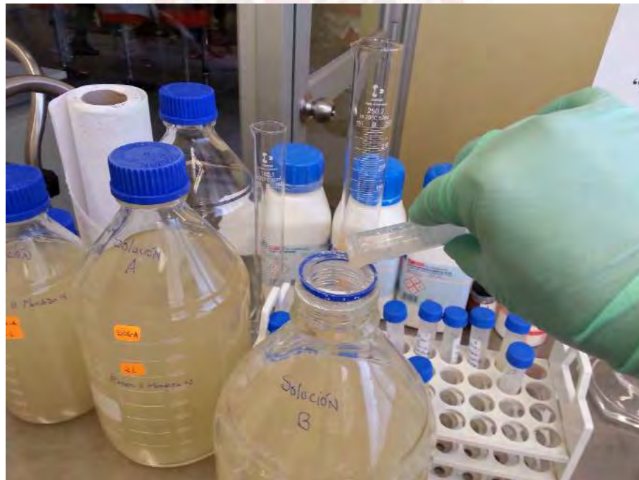
Figura 60. Adición de esporas de Bacillus subtilis a solución B.
