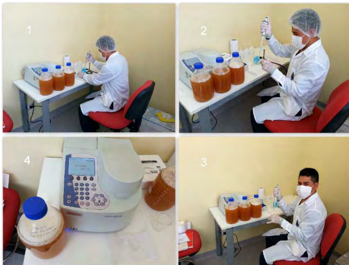
Figura 13. Es preciso indicar que, en esta lectura (última) mediante el espectrofotómetro, indicó que se tiene el pico de crecimiento y es momento de retirar el cultivo bacteriano de la incubadora.
