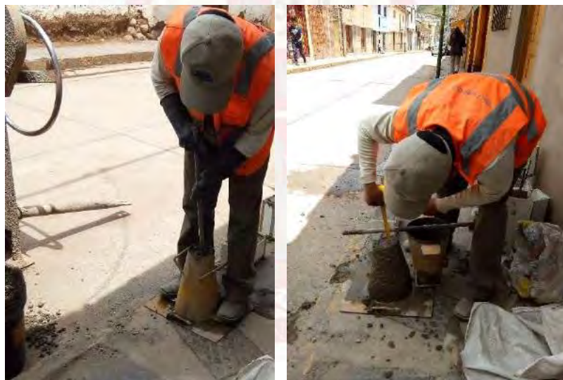
Figura 31. Ensayo de revenimiento del concreto (consistencia - slump).
