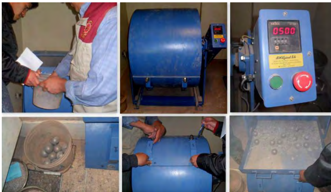
Figura 22. Ensayo de abrasión del agregado grueso.
