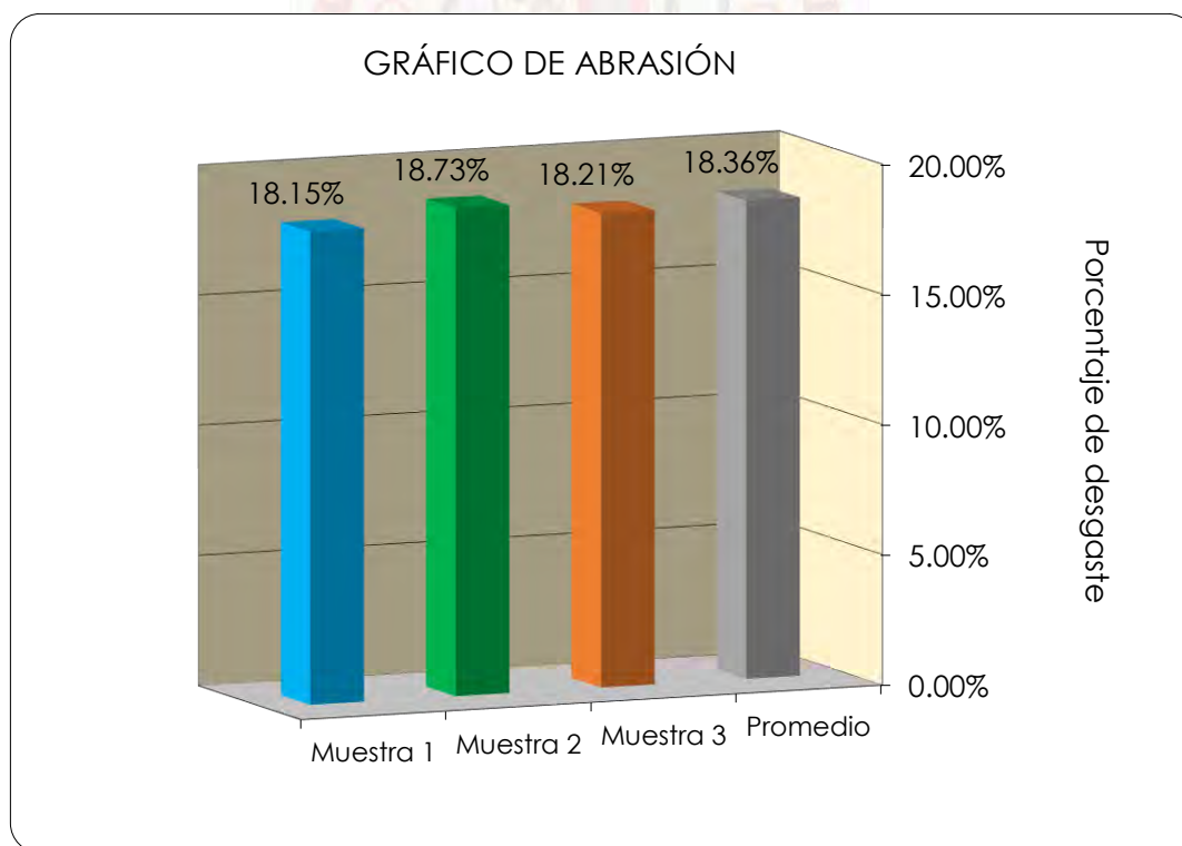
Figura 75. Desgaste a la abrasión del agregado grueso.
