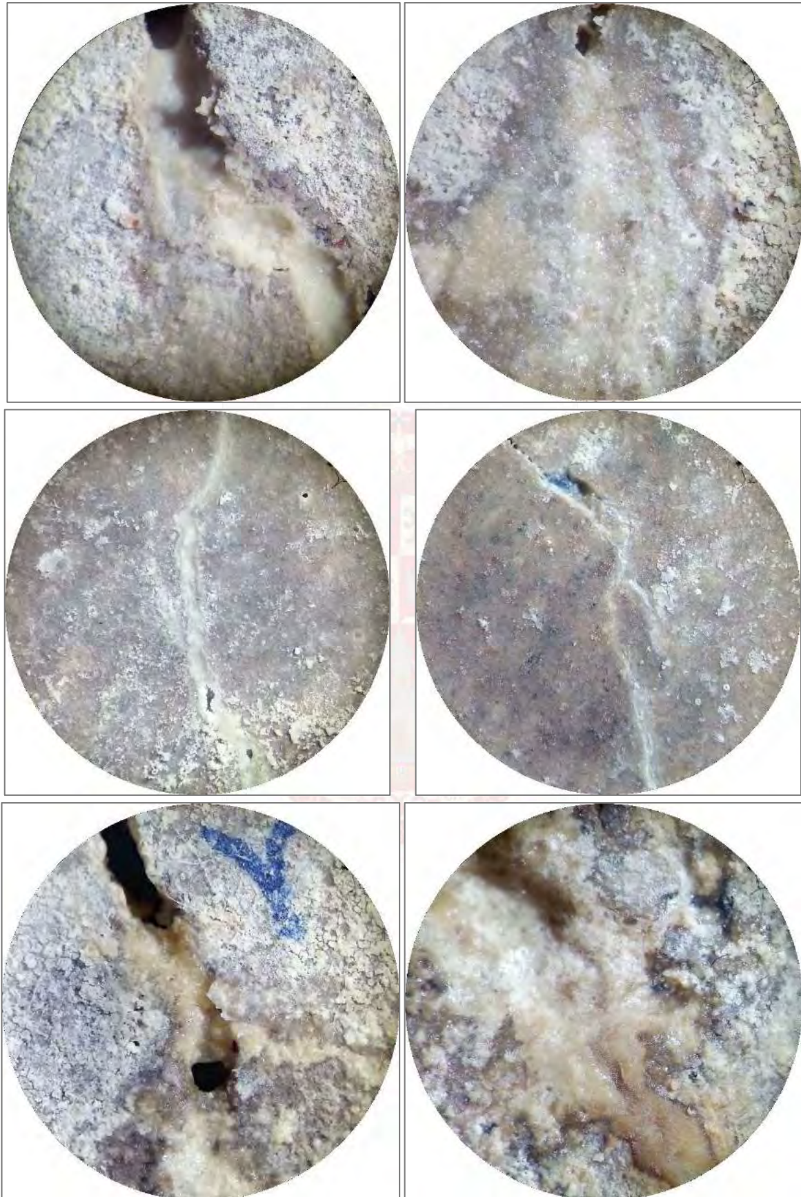
Figura 113. Observación estereoscópica de la precipitación de \text{CaCO}_3 a base de bacterias a los 86 días.
