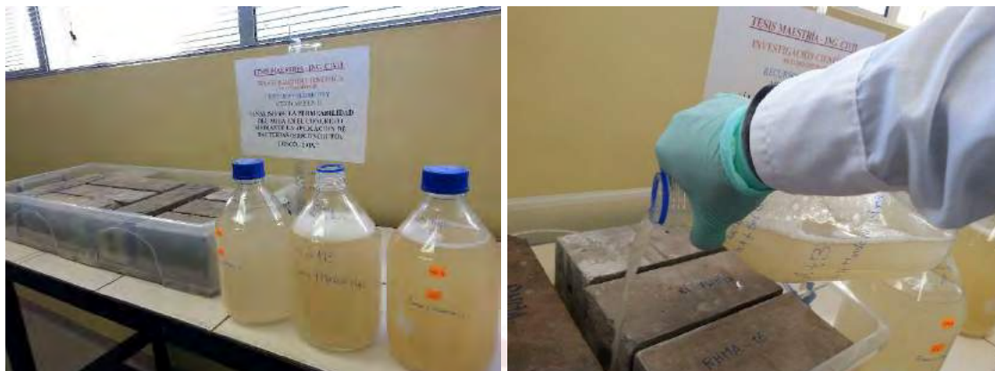
Figura 63. Adición de la solución bio-precipitadora para la reparación de prismas fisuradas.
