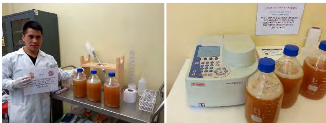
Figura 15. Lectura en el espectrofotómetro (máxima concentración de bacterias = 1.259).
