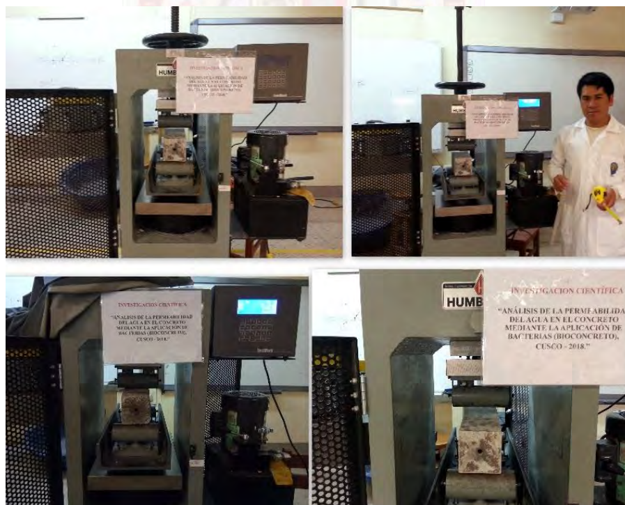
Figura 44. Ensayo a flexión de prismas de concreto.
