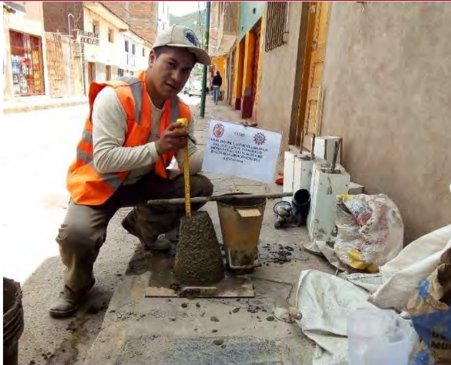
Figura 32. Revenimiento del concreto (consistencia – slump).
