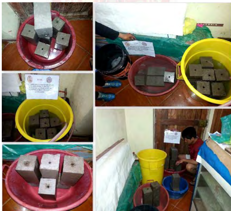
Figura 41. Curado de prismas de concreto.
