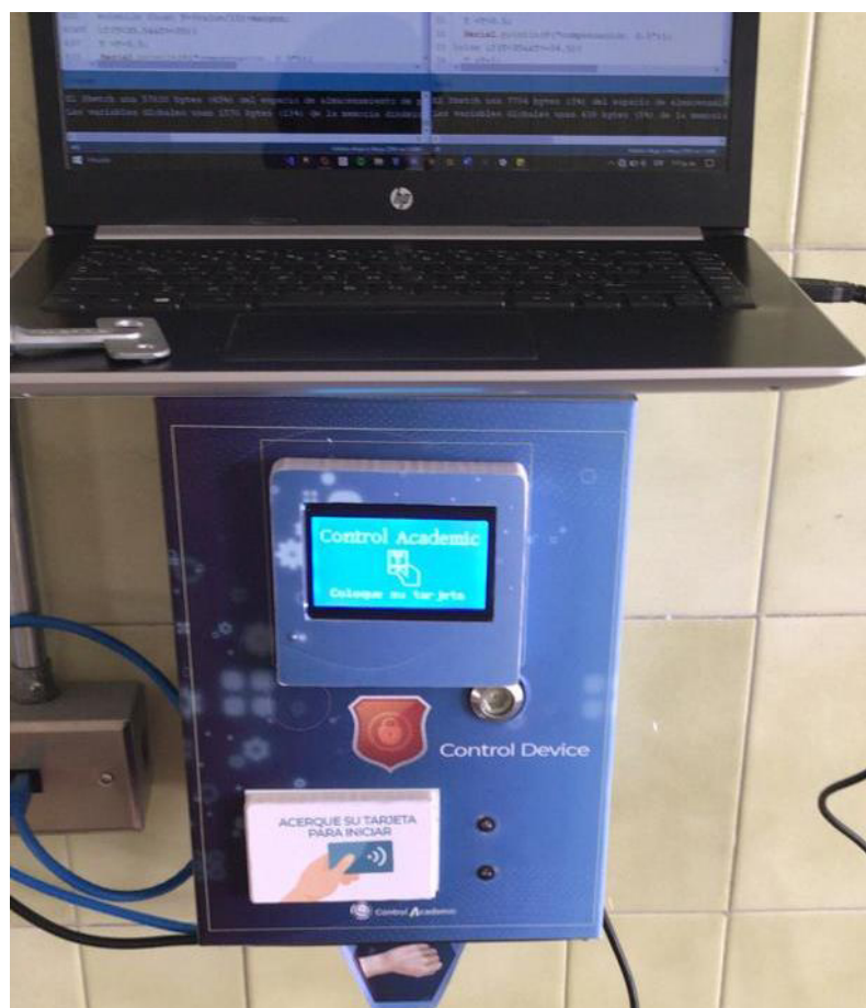
Fig. 13. Configuración del equipo y el case (gabinete) con todos los elementos ensamblados. Fuente: Autores.
