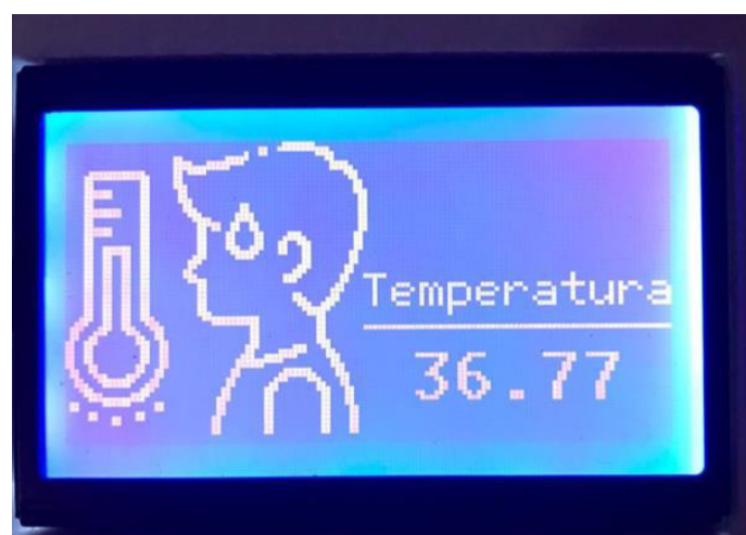
Fig. 14. Pantalla LCD que muestra la temperatura del trabajador. Fuente: Autores.
