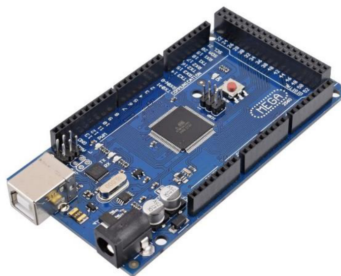
Fig. 6. Arduino Mega 2560. Fuente: Autores.
