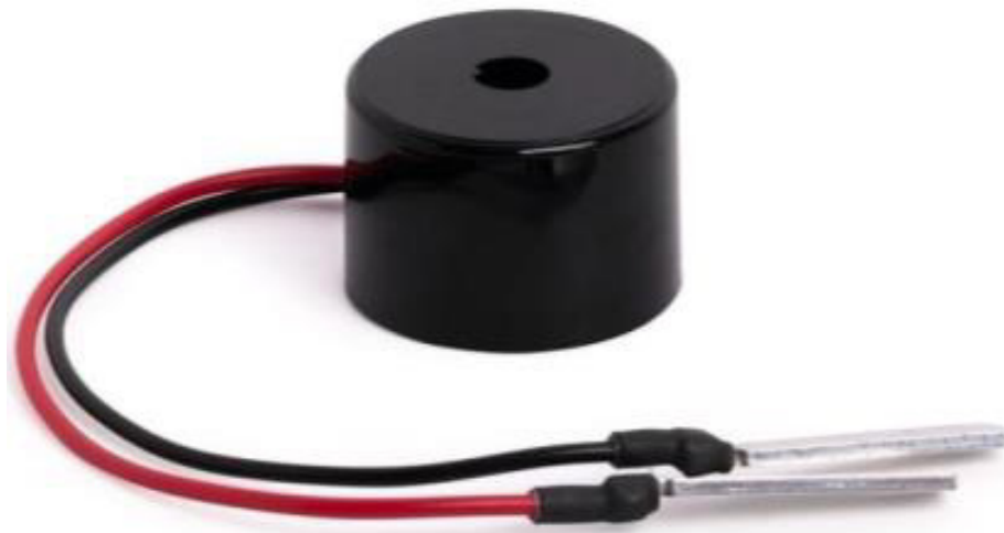
Fig. 7. Buzzer piezoeléctrico. Fuente: Autores.
