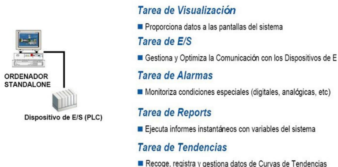
Fig. 1. Tareas de supervisión con Citect SCADA.
