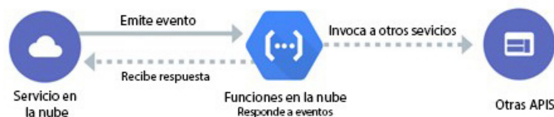
Fig. 1. Flujo de eventos de llamado a una función en la nube. Fuente Google Cloud [18].
