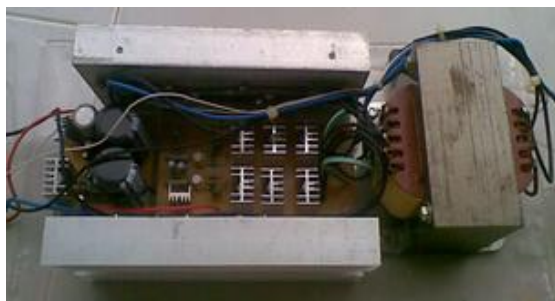
Gambar 10. Prototipe inverter 1 fasa, dan sistem pengukuran arus dan tegangan keluaran
