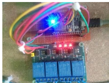
Gambar 7. Pengujian Node MCU dan Relay.
