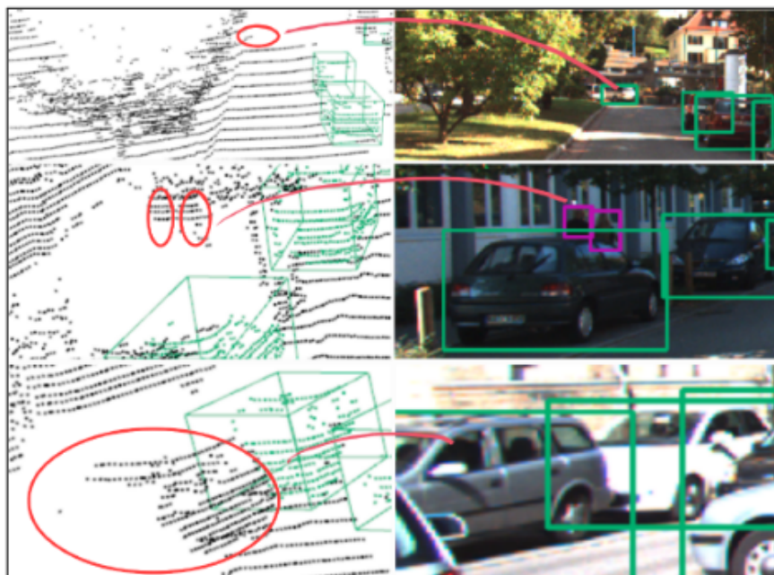
Figura 3.26: Ejemplos de objetos pasados por alto por el detector 3D pero reconocidos por el detector 2D. Desde arriba: fuera de alcance, parcialmente ocluido, fallo del detector
