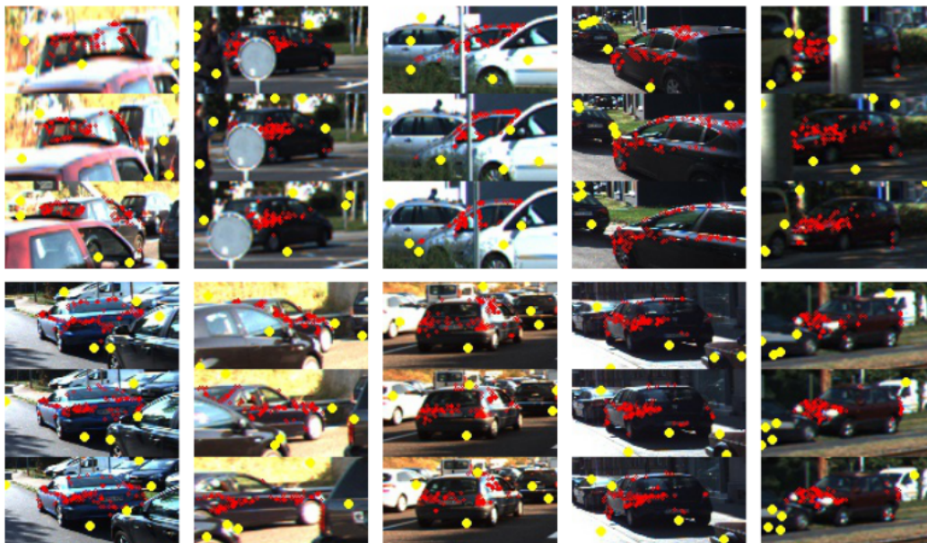
Figura 3.22: Visualización de los puntos críticos. Los puntos rojos y amarillos representan los puntos críticos del primer plano y los puntos críticos del entorno, respectivamente [32].
