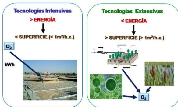
Figura 4. Comparación de pros y contras: Tecnologías Intensivas y Extensivas (Fuente: Río et al., 2015; Salas, 2018b).
