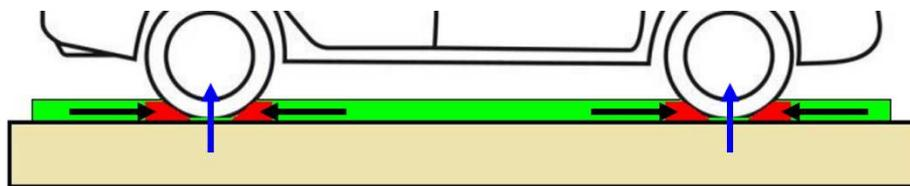
Figura 47. Representación de la elevación del vehículo con la plataforma de desplazamiento lineal.
