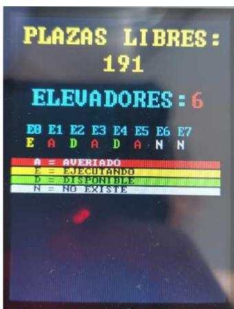
*Figura 86. Display HY28A tras un programa simulación.*
