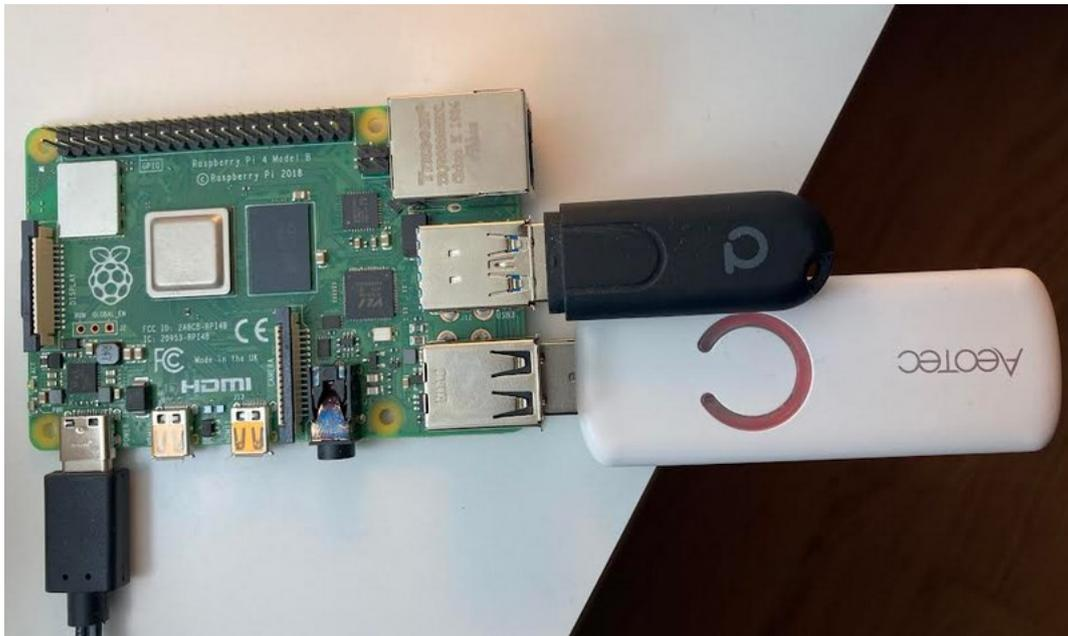
*Figura 24 Ejemplo de montaje RPI y adaptadores ZB y ZW*
