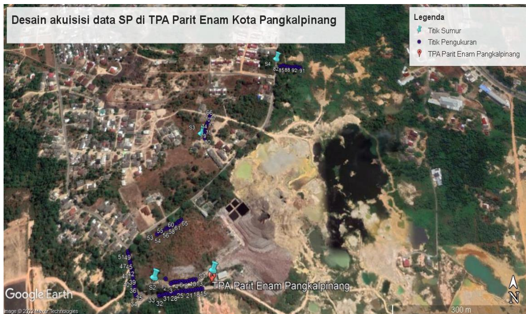
Gambar 3. Desain akuisisi data SP di TPA Parit Enam Kota Pangkalpinang
