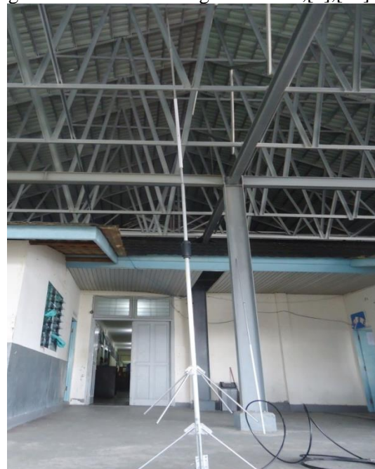
Gambar 13. Bentuk Akhir Antena Vertical 2 Meter Band 2 \times \frac{5}{8} \lambda Menggunakan Sistem Sephasa.
