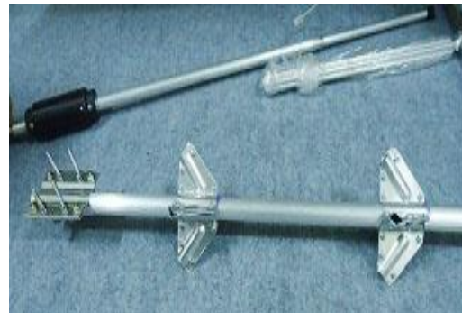
Gambar 7. Clamps Radial Antena yang Telah Dipasang.
