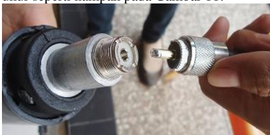
Gambar 11. Pemasangan Kabel Koaksial ke Loading Impedansi.
