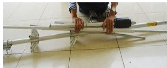
Gambar 9. Penyambungan dan Pipa Paralon pada Antena.
