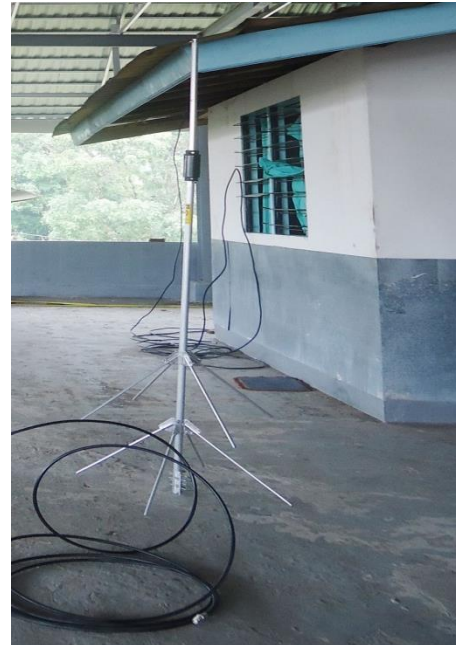
Gambar 12. Bentuk Antena Vertical \frac{5}{8} \lambda .
