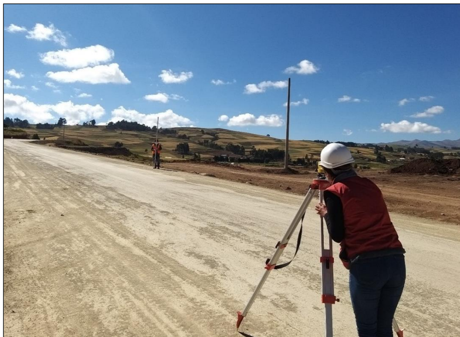
Figura 24: c). Toma de puntos para hallar los desniveles del tramo de la carretera Izcuchaca – Cruzpata con el objetivo de generar pendientes en la vía a evaluar (29 de Mayo del 2021).
