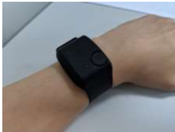
Figure 8 - The Empatica E4 biosensor (“Empatica”).
