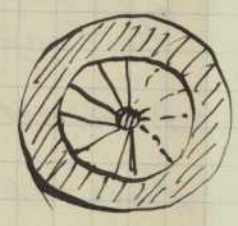
Wendeltreppe mit hohler Spindel
