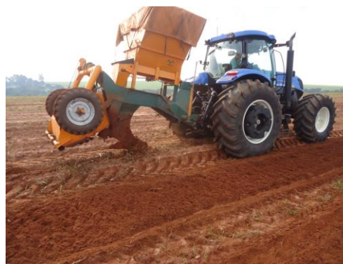
Figura 1. Equipamento utilizado para preparo profundo e canteirizado do solo.
