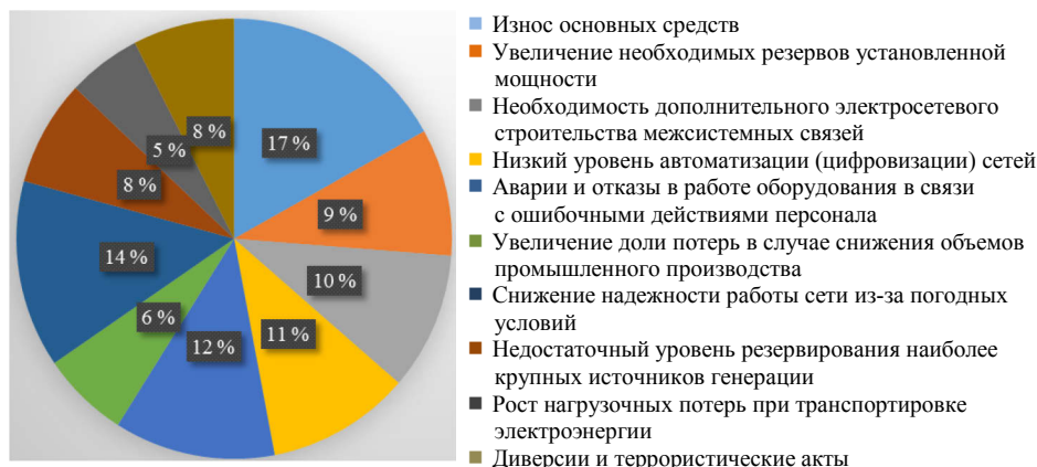
Рис. 5. Важность производственных рисков энергетической безопасности на стадии передачи
