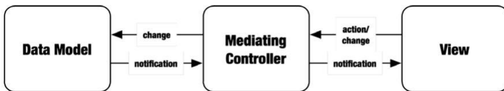
Figura 6: Patrón de diseño modelo-vista-controlador mediado.
