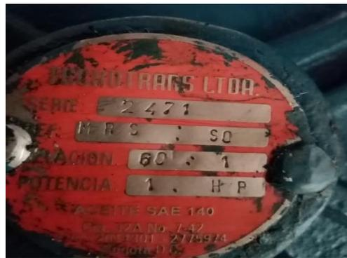
**Figura 27-3:** Placa del reductor de velocidad de la banda transportadora
