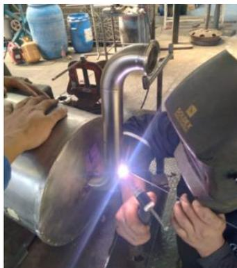
**Figura 86-3:** Unión del codo a 45° con el tubo de la línea de descarga.
