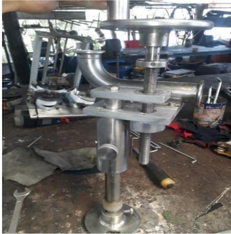
**Figura 9-3:** Desmontaje del dosificador
