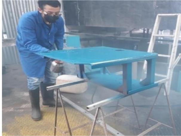
**Figura 19-3:** Pintura de la mesa del mecanismo de la cruz de malta.
