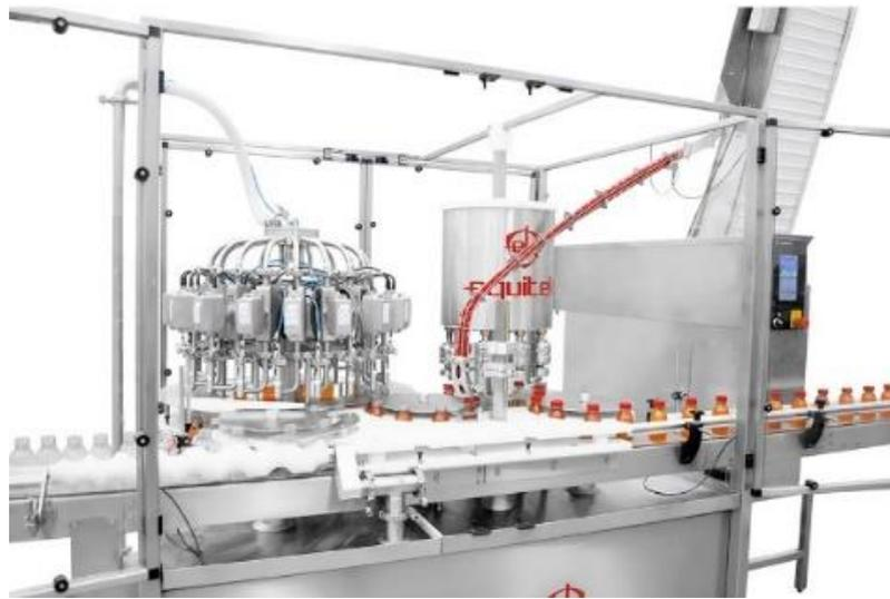
**Figura 5-2:** Equipo para envasado de productos líquidos por volumen, rotativo
