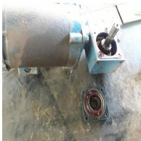
**Figura 15-3:** Pulido del motor de la cruz de malta.
