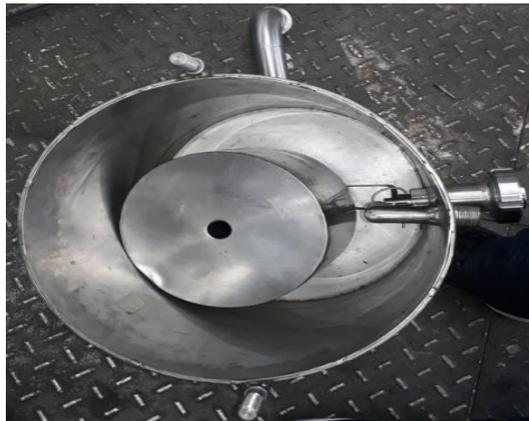
**Figura 90-3:** Implementación del flotador en el tanque de almacenamiento de yogurt.
