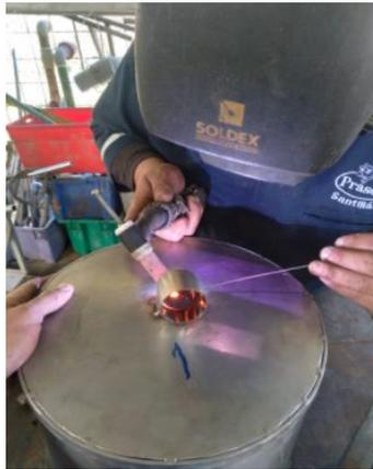
**Figura 85-3:** Proceso de soldado TIG del codo a 45° con varilla 316L.
