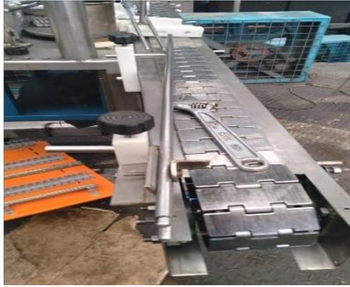
**Figura 35-3:** Montaje de la banda de placas articuladas.
