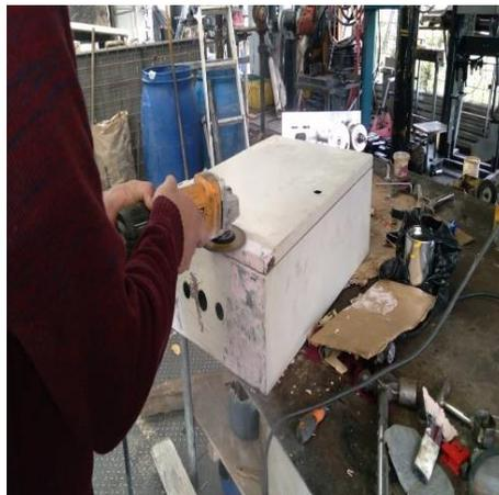
**Figura 14-3:** Pulido del cuadro principal del sistema eléctrico
