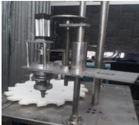
**Figura 25-3:** Componentes de la etapa de dosificado y roscado
