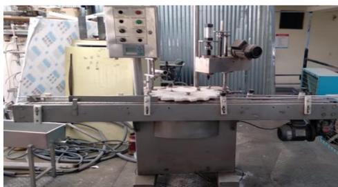
**Figura 1-3:** Vista frontal de la máquina envasadora
