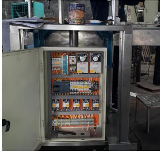
**Figura 70-3:** Montaje del tablero eléctrico de la envasadora.
