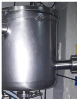
**Figura 87-3:** Línea de succión del tanque de almacenamiento del yogurt.
