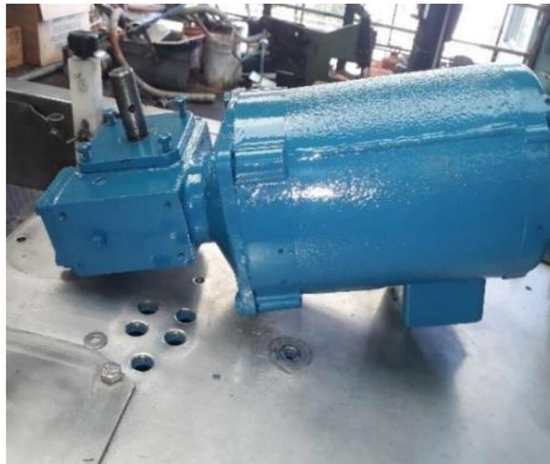
**Figura 20-3:** Pintura de la carcasa del motorreductor
