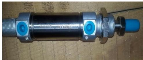
**Figura 79-3:** Cilindro neumático INOX de doble efecto 25x25.
