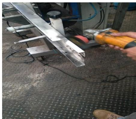
**Figura 18-3:** Pulido de la cubierta de la banda transportadora.
