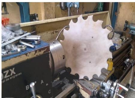
**Figura 23-3:** Desbastado de la estrella de la cruz de malta mediante torno
