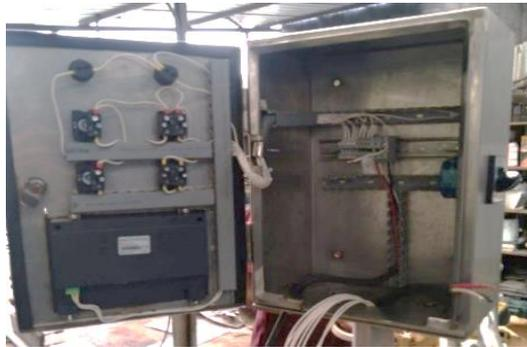
**Figura 71-3:** Montaje del tablero de mandos de la envasadora
