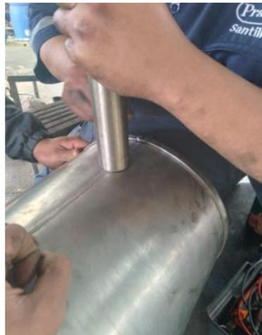
**Figura 84-3:** Trazado de la línea de succión y descarga.
