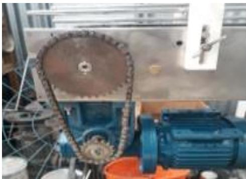
**Figura 36-3:** Montaje y alineación del motorreductor
