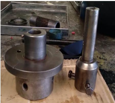
**Figura 39-3:** Leva y porta eje para acoplar el motorreductor
