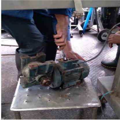
**Figura 8-3:** Motorreductor desvinculado del sistema
