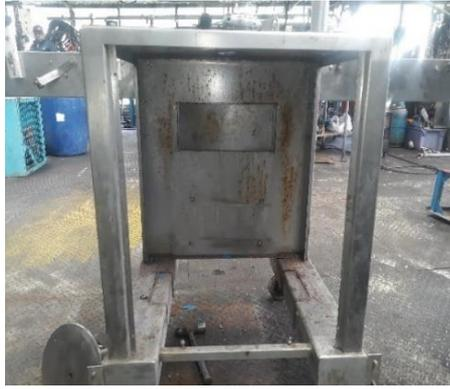
**Figura 21-3:** Bastidor cubierto de óxido
