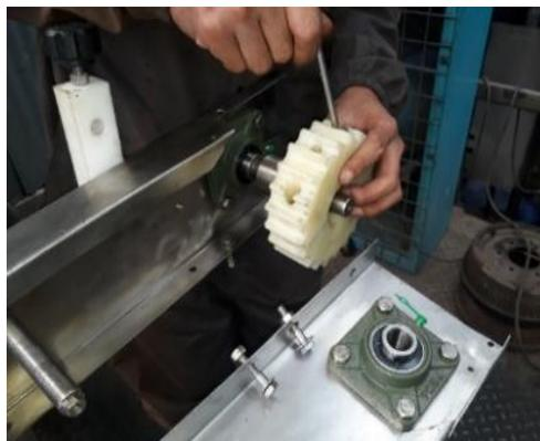
**Figura 34-3:** Montaje del piñón conductor de la banda transportadora
