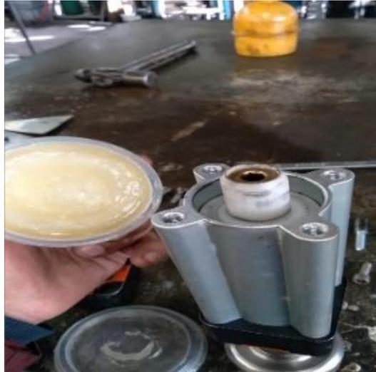
**Figura 33-3:** Vaselina industrial para lubricar los cilindros neumáticos
