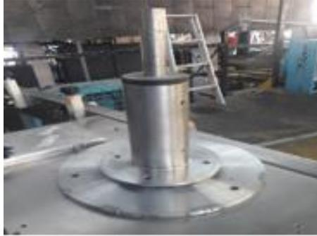
**Figura 37-3:** Eje conductor de la mesa rotativa.
