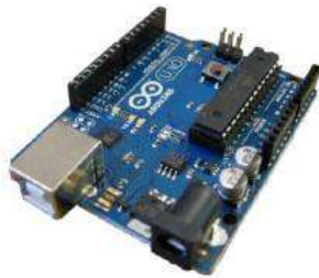
Arduino UNO con microcontrolador en formato DIP
