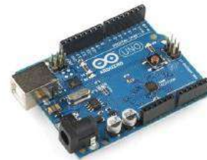
Arduino UNO con microcontrolador en formato SMD
