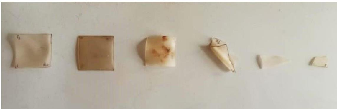
**Figura 5-3:** Proceso de biodegradabilidad de biofilms en Aire
