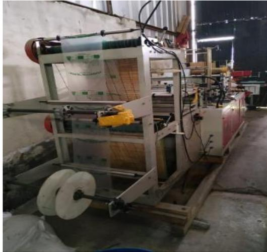
**Figura 23-3.** Maquina pre corte en el área de producción
