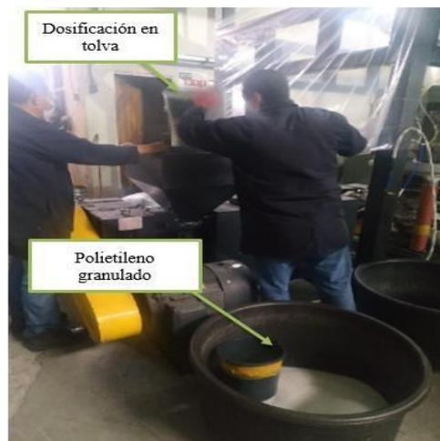
**Figura 5-3.** Dosificación de polietileno en tolvas de distribución
