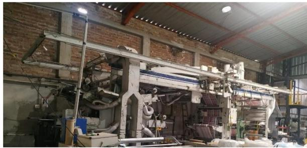
**Figura 12-3.** Máquina impresora flexográfica COMEXI en el área de producción
