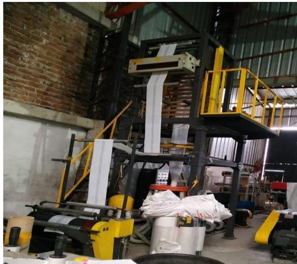
**Figura 8-3.** Máquina extrusora de baja densidad en el área de producción
