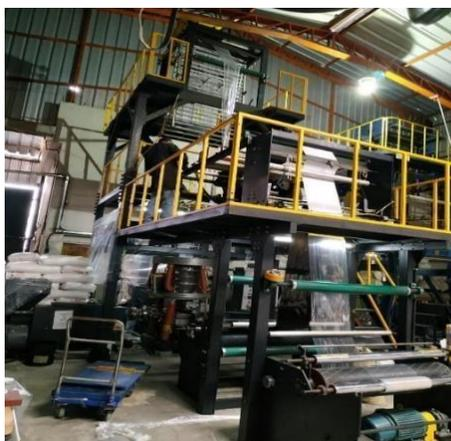
**Figura 6-3.** Máquina Coextrusora de 3 ejes en el área de producción
