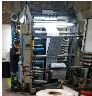
**Figura 11-3.** Máquina impresora flexográfica de 6 tintas en el área de producción
