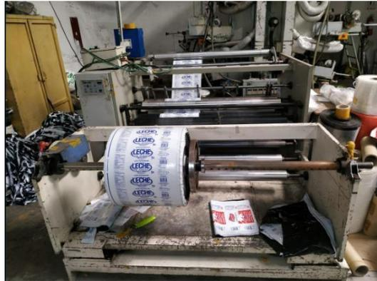
**Figura 13-3.** Máquina refiladora
