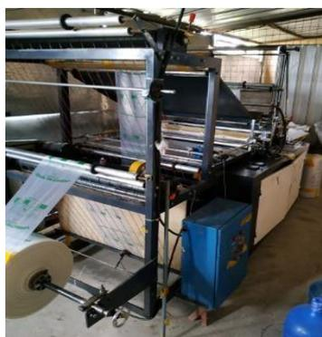
**Figura 21-3.** Máquina selladora China en el área de producción
