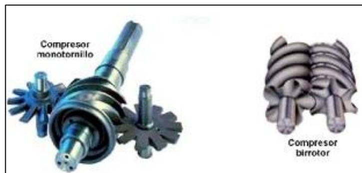
**Figura 15-1:** Compresor de tornillo
