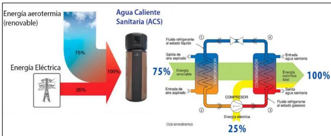
**Figura 1-2.** Esquema bomba de calor Aire-Aire
