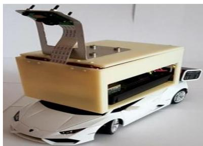
**Figura 4-1:** Prototipo tipo Ackermann con cámaras de visión artificial
