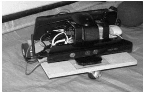
**Figura 5-1:** Prototipo de visión artificial con Kinect 360, Arduino y Open CV
