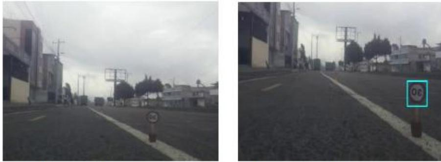
**Figura 33-2:** Detección en tiempo real de señales de Tránsito con el algoritmo
