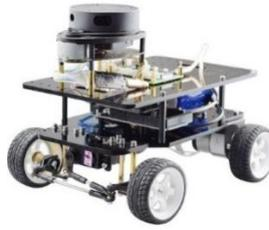
**Figura 8-3:** Prototipo Ackerman, cámara LIDAR.
