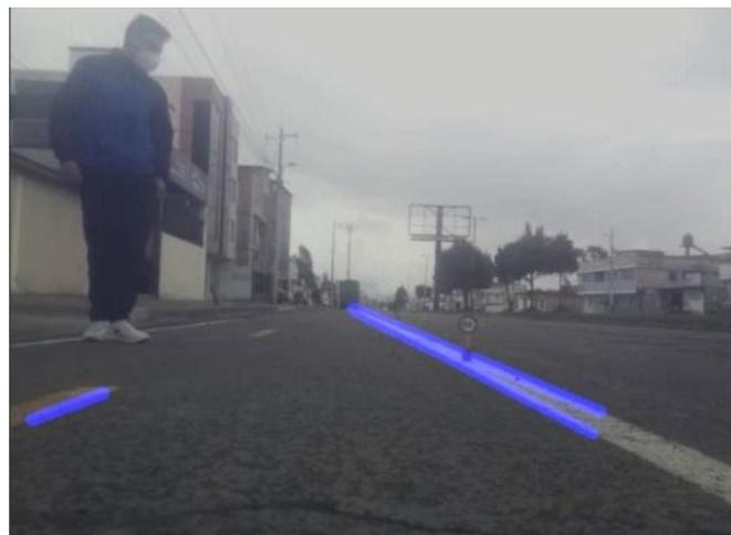
**Figura 36-2:** Transformada de Hough
