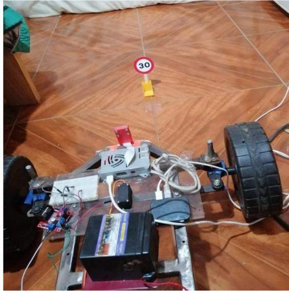
**Figura 39-2:** Detección de señal de velocidad mediante la Raspberry.
