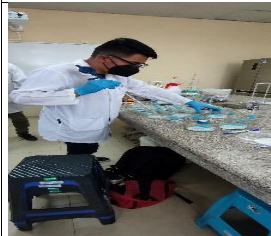
Distribución de 5mL de los estándares de aluminio en las cajas Petri.
