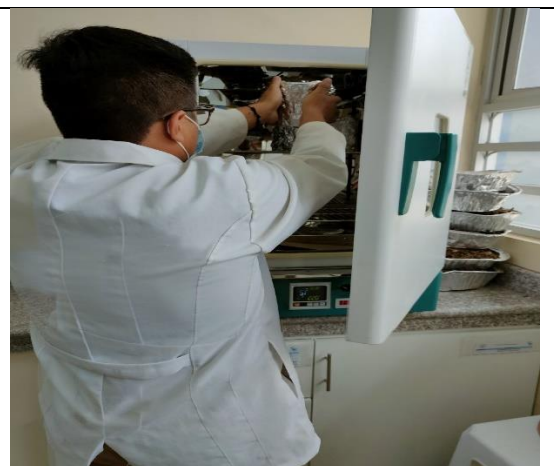
Conservación de las cajas Petri en la estufa a 22\text{ }^{\circ}\text{C} \pm 2\text{ }^{\circ}\text{C}
