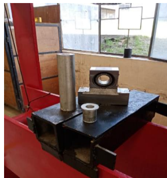
Figura 14-3: Colocación de rodamiento de prueba
