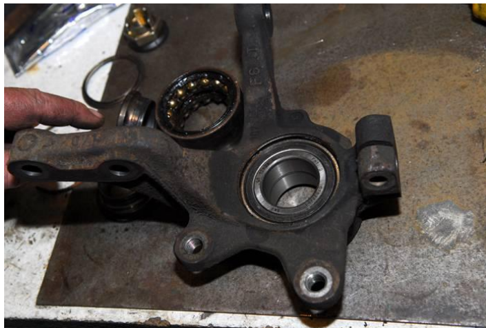
Figura 4-2: Cambio de rodamiento en el brazo delantero el auto
