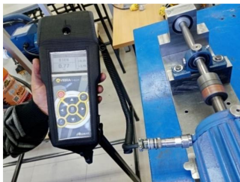
Figura 4-3: Evaluación de rodamientos VibraCHECK 200
