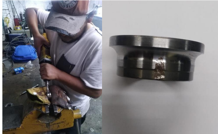
Figura 17-3: Inducción de picadura en los rodamientos
