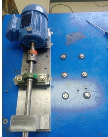
Figura 6-3: Pernos de sujeción para el módulo.
