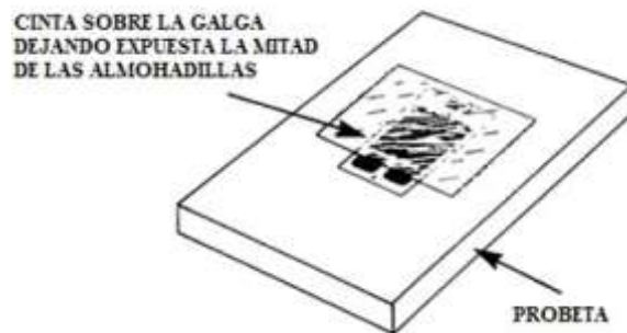
Figura 10-4: Protección a la galga previo a la soldadura. Fuente: (17).
