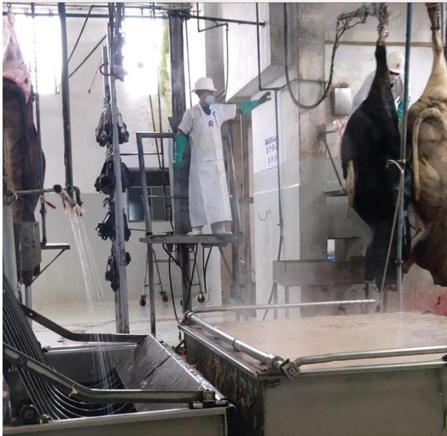
**Figura 12-2** Izado, Corte de patas y desollado de la piel
