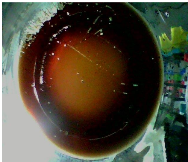
Fotografía 8-2: Imagen del óxido de grafeno en el vidrio reloj recuperado, pasadas 24h de secado en un horno convencional.
