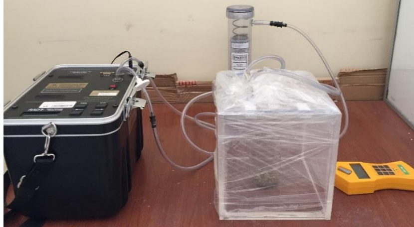
Fotografía 11-2: Ensayo experimental de la tasa de fuga de la cámara.
