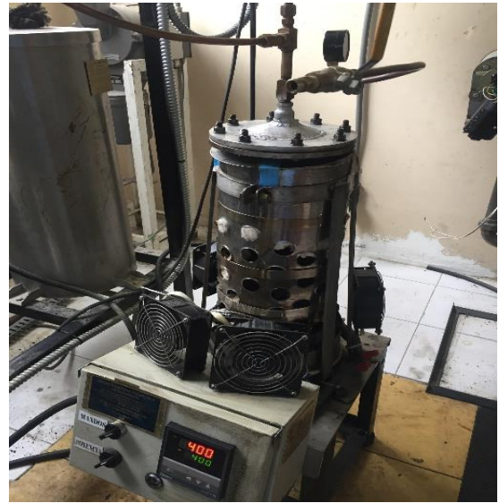
Fotografía 3-2: Reactor de pirólisis.
