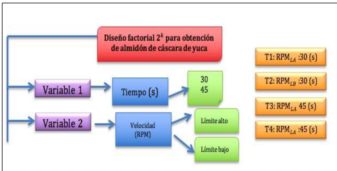
Figura 2-1. Diseño factorial 2^k , para obtención de almidón de cáscara de yuca
