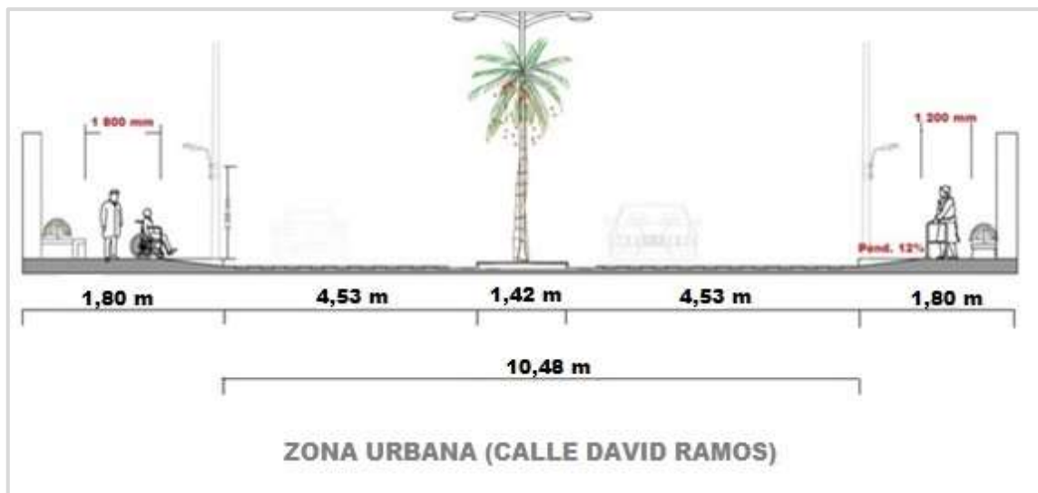
Figura 33-3: Dimensiones de los andenes de accesibilidad - Calle David Ramos Realizado por: Jácome R., Naranjo L., 2021
