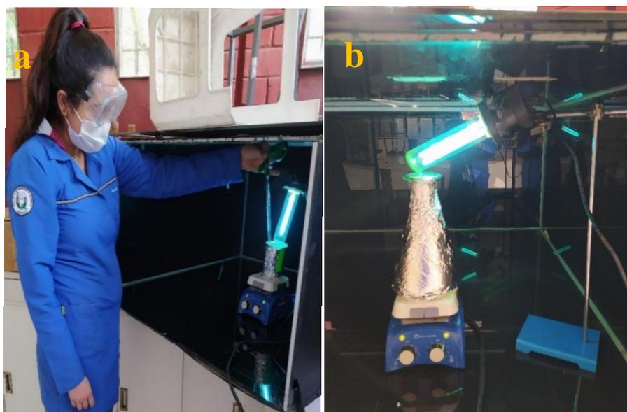
**Figura 4-2:** a) Diseño del fotorreactor con fuente continua de radiación UV
