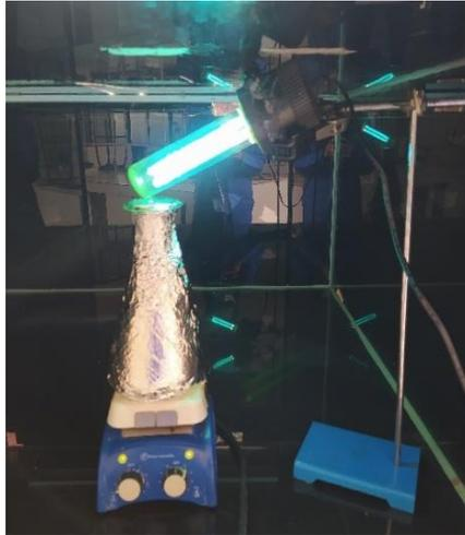
**Figura 1-3.** Diseño del fotorreactor.
