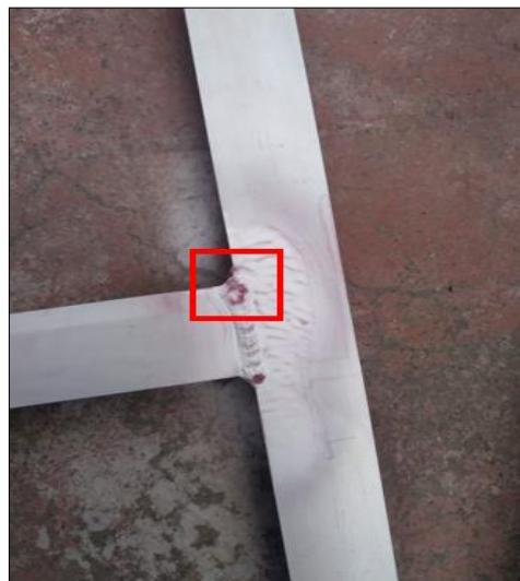
Figura 5-4: Visualización de prueba de soldadura con grieta
