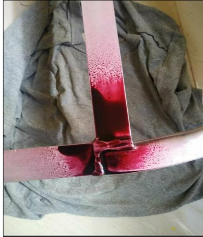
Figura 3-4: Aplicación de líquido penetrante
