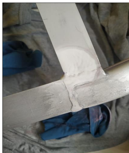
Figura 4-4: Revelado de prueba de soldadura
