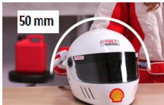
Figura 39-2: Barra Antivuelco 50 mm alrededor del casco
