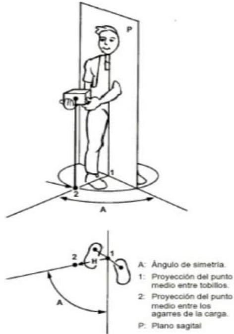
Figura 5-2: Ángulo de Simetría de Levantamiento
