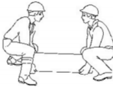
Figura 6-4: Levantamiento de la carga con ayuda de un compañero
